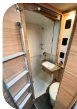
Kabinę prysznicową w łazience zabudowujemy z części (około 1/4) tylnego łóżka. To bardzo proste
