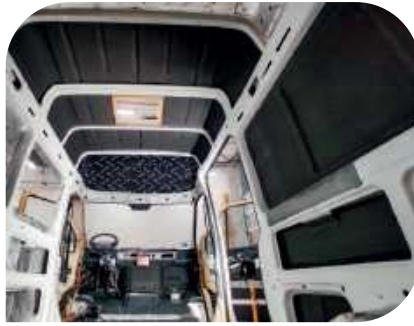
Przykłady izolacji termicznej produktami Bitmat
