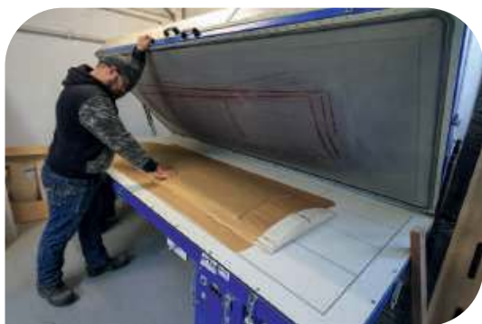
Balcamp samodzielnie tworzy płyty sandwichowe do produkowanych kamperów. W przypadku kampervanów takie formatki gwarantują ciepłą podłogę
