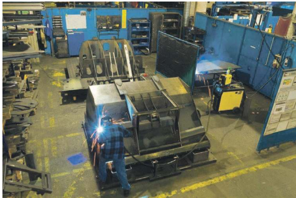
Jednym z najważniejszych elementów procesu produkcji jest spawanie konstrukcji ciężkich
