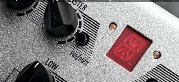
Przycisk MUTE/TUNER służy do załączenia pokładowego tunera.
