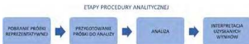
Rysunek 1. Schemat obrazujący etapy procedury analitycznej.
