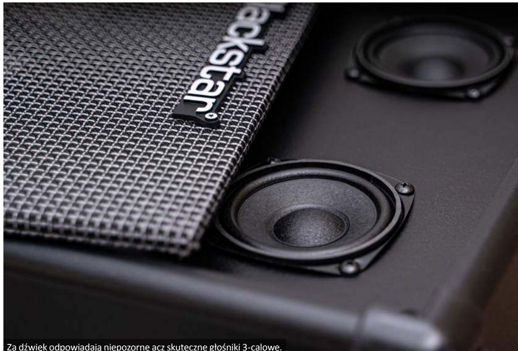
Za dźwięk odpowiadają niepozorne acz skuteczne głośniki 3-calowe.
