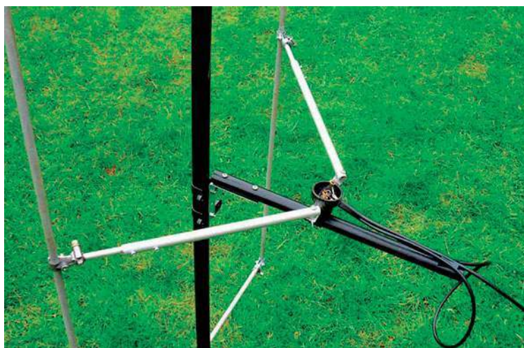
Konstrukcja obwodu dopasowującego wykonanego z rurek teleskopowych
