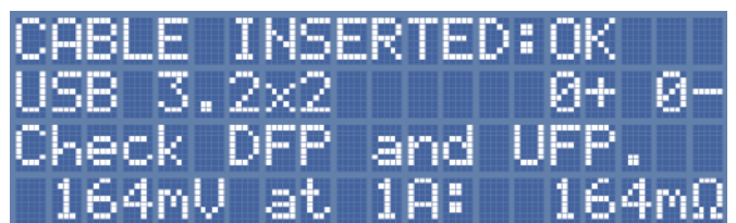
Ekran 8. Typowy wynik testu kabla USB-C do USB-C pokazuje to, czego oczekuje się od w pełni kompatybilnego kabla USB 3.2 z dwoma liniami SuperSpeed , co oznacza, że ma on parę USB 2.0 D+/D-, a także przewody SuperSpeed
