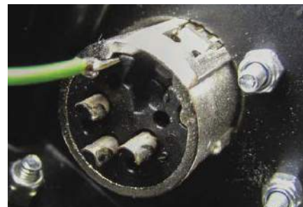
Rysunek 27. Metalowe obudowy można uziemić przez gniazda XLR za pomocą końcówki uziemienia z tyłu gniazda podłączonego do zasilacza 0 V
