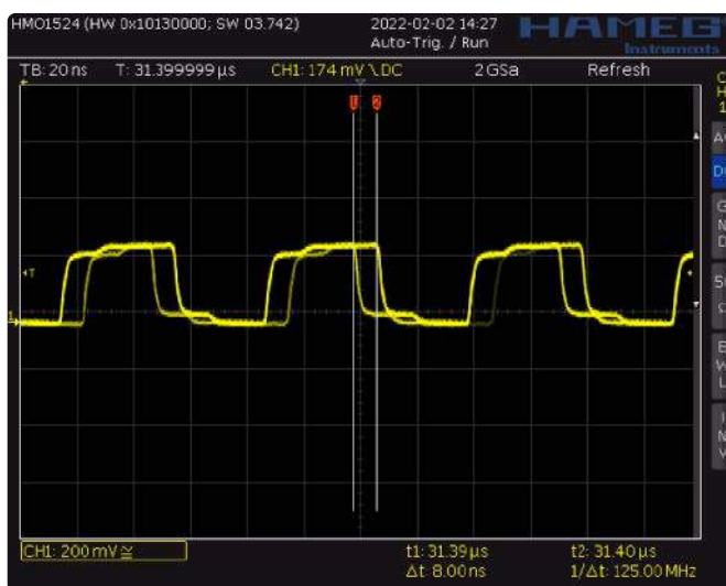
Rysunek 5. Wygenerowany sygnał zegarowy wykazuje drżenie zbroczy (jitter)
