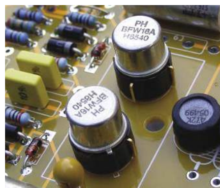
Rysunek 33. Tranzystory powinny być montowane w podstawkach, aby można było łatwo wymienić, na lepsze, te, które są zbyt szumiące. Tranzystory Hitachi, Toshiba, Sanyo i Rohm wydają się być najlepsze. Tylko elektrony pasjonaci mają na to czas, więc możliwe jest uzyskanie lepszych parametrów niż w seryjnych urządzeniach
