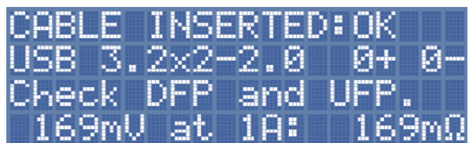
Ekran 10. Ponieważ kable USB-C są odwracalne, konieczne jest przetestowanie ich w obu orientacjach. Jeśli ten ekran jest widoczny, bieżąca orientacja nie łączy pary D+/D- i należy wypróbować inną orientację
