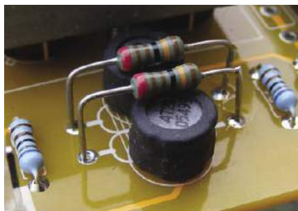
Rysunek 31. Aby zredukować niewielką ilość dzwonięcia przy przebiegach prostokątnych, dławiki filtrów wejściowych L1 i L2 można wytyczyć, podłączając do nich rezystory 1,3 k \Omega (R28 i R29)
