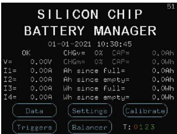
Ekran 1. Ekran główny Battery Multi Logger został zmodyfikowany w celu dodania dwóch nowych przycisków dla funkcji „Trigger” i „Balancer”. W prawym dolnym rogu wyświetlany jest stan wyzwalania, a tytuł został również zmieniony, aby odzwierciedlić nowe możliwości urządzenia
