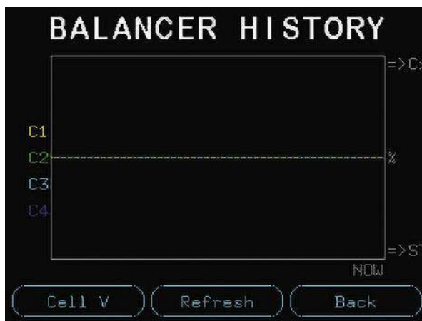
Ekran 7. Strona BALANCER HISTORY zawiera informacje o ostatnich działaniach Balancera , w tym wyświetla komórki, które są balansowane i w którym kierunku
