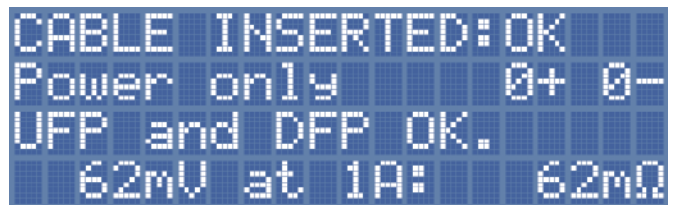
Ekran 6. Po założeniu zworek JP1 i JP2 zgłaszana jest tylko wewnętrzna rezystancja testera. Wartość na dole ekranu to rezystancja styku. Podobny ekran jest widoczny, gdy do testowania jest podłączony kabel używany tylko do zasilania
