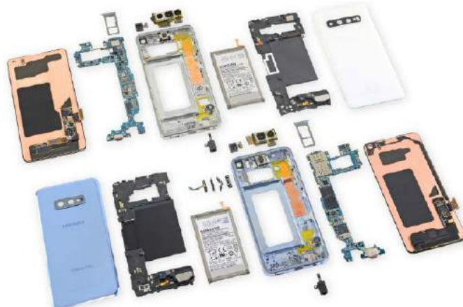
Rysunek 3. Niewymienny akumulator w smartfonie pozwala na zastosowanie niestandardowych ogniw o większej pojemności oraz ułatwia zapewnienie wysokiej klasy szczelności urządzenia. Niestety oznacza to też, że wymiana najszybciej starzejącego się elementu wymaga tak naprawdę wykonania naprawy sprzętu, zamiast stanowiąc czynność eksploatacyjną, wykonywaną przez użytkownika
