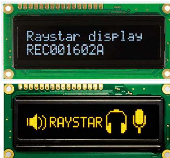
Fotografia 1. Wyświetlacze PMOLED to idealny zamiennik pasywnych wyświetlaczy LCD w aplikacjach wymagających lepszej estetyki (źródło: Raystar)
