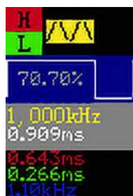
Rysunek 11. Wynik pomiaru sygnału 1 kHz
