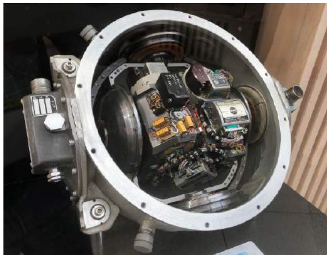
Fotografia 1. Urządzenie starej generacji służące do nawigacji inercyjnej
