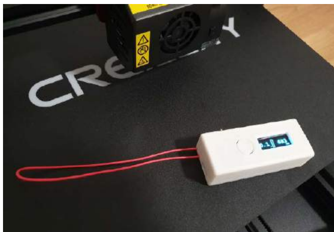
Fotografia 2. Układ w obudowie wykonanej w technologii druku 3D
