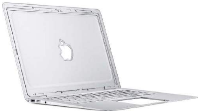
Rysunek 2. Świetnym przykładem zmniejszenia kosztów montażu jest MacBook Unibody firmy Apple, w którym obudowa laptopa składa się tak jakby jedynie z dwóch elementów. I o ile taka konstrukcja prowadzi do uzyskania estetycznego wyglądu oraz nie zaczyna z czasem trzeszczeć, prowadzenie wszelkich napraw jest znacznie utrudnione
