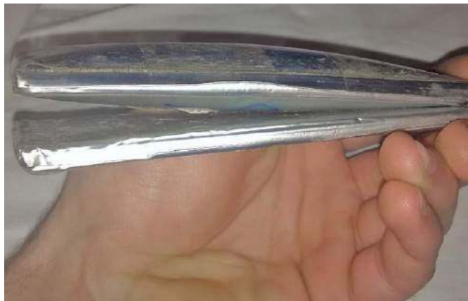
Fotografia 2. Dwa ogniwa pryzmatyczne, jedno spuchnięte
