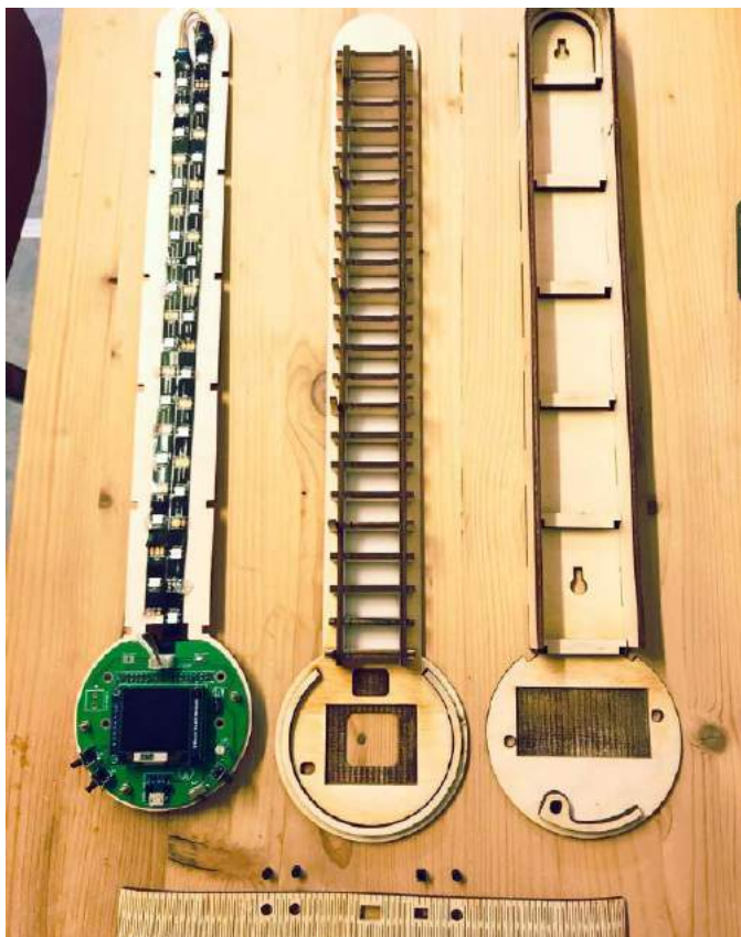
Fotografia 1. Częściowo zmontowana konstrukcja z widocznymi elementami obudowy
