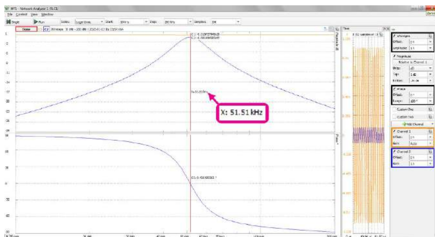
Rysunek 19. Pomiar I=f(f) w rzeczywistym układzie za pomocą Analog Discovery 2
