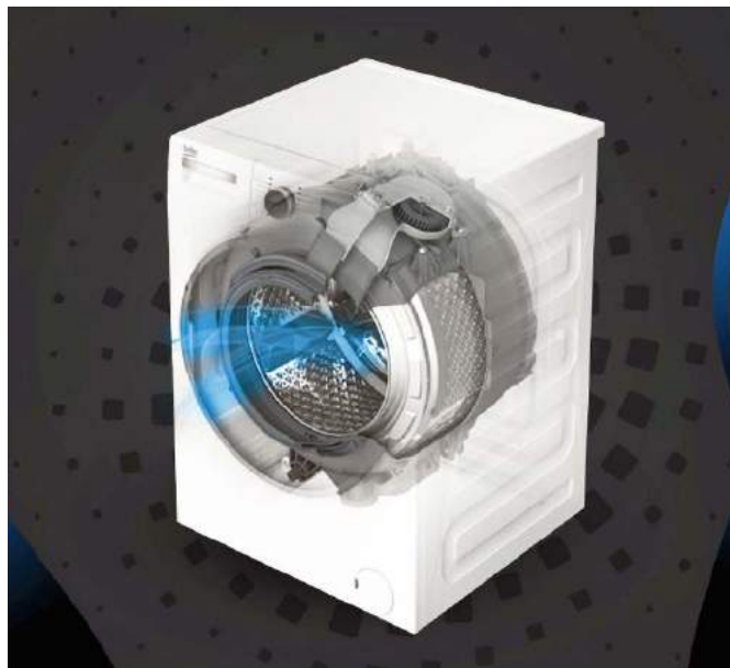
Rysunek 1. Zespół piorący pralki, w którym silnik zintegrowano z bębnem jest tańszy w produkcji oraz reklamowany jako bardziej niezawodny, ze względu na brak obecności paska klinowego, przenoszącego napęd. Niestety, w przypadku wystąpienia awarii konieczna staje się wymiana całego zespołu, co w praktyce oznacza koszt naprawy na poziomie ceny nowej pralki
