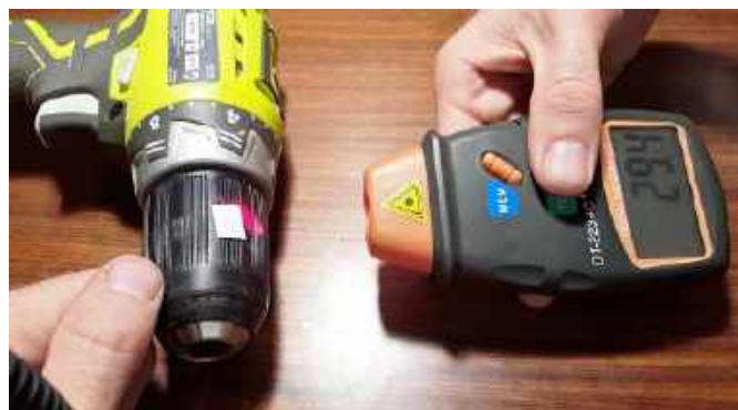
Fotografia 4. Pomiar prędkości obrotowej wkrętarci z użyciem znacznika samoprzylepnego i tachometru laserowego ( http://t.ly/sIM0- )
