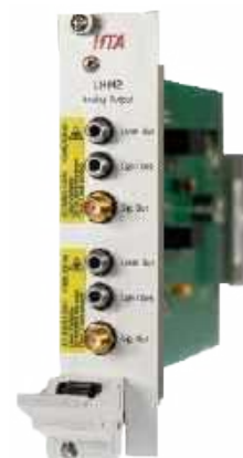
Fotografia 12. Karta rozszerzeń z funkcją dwukanałowego tachometru światłowodowego marki IFTA Systems ( http://t.ly/VzMbb )
