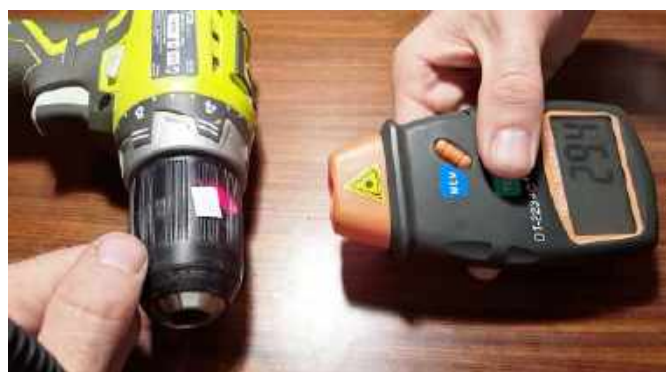
Fotografia 4. Pomiar prędkości obrotowej wkrętkarki z użyciem znacznika samoprzylepnego i tachometru laserowego ( http://t.ly/sIM0- )
