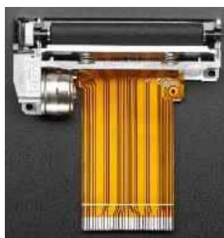
Fotografia 8. Mechanizm termiczny wyposażony w taśmę FPC z wyraźnie widocznymi poszerzeniami ścieżek przenoszących duże obciążenia ( http://tinyurl.com/4u4zap2h )
