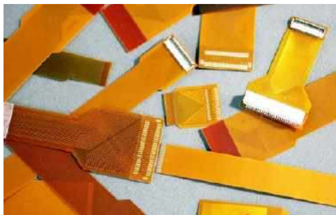
Fotografia 3. Przykładowe adaptory wykonane w technologii FPC ( https://tinyurl.com/4db83v5m )
