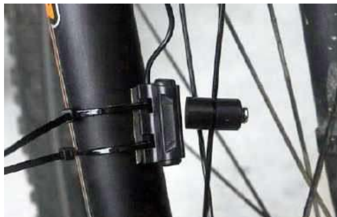
Fotografia 3. Czujnik kontaktronowy (po lewej) współpracujący z magnesem zamontowanym na jednej ze szprych (po prawej) – http://t.ly/Wln04
