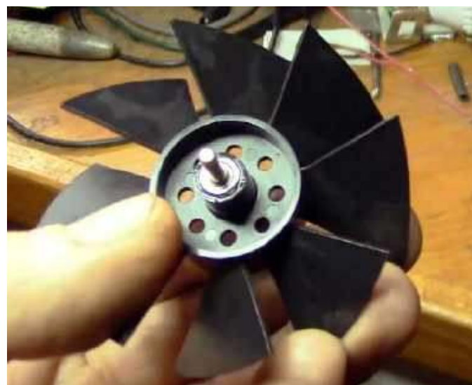
Fotografia 8. Wiatraczek anemometru z widocznym szeregiem otworów współpracujących z barierą optyczną ( http://t.ly/vJOp4 )
