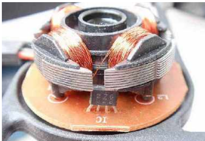
Fotografia 9. Hallotron zamontowany na płycie sterownika wentylatora ( http://t.ly/Y_U3v )
