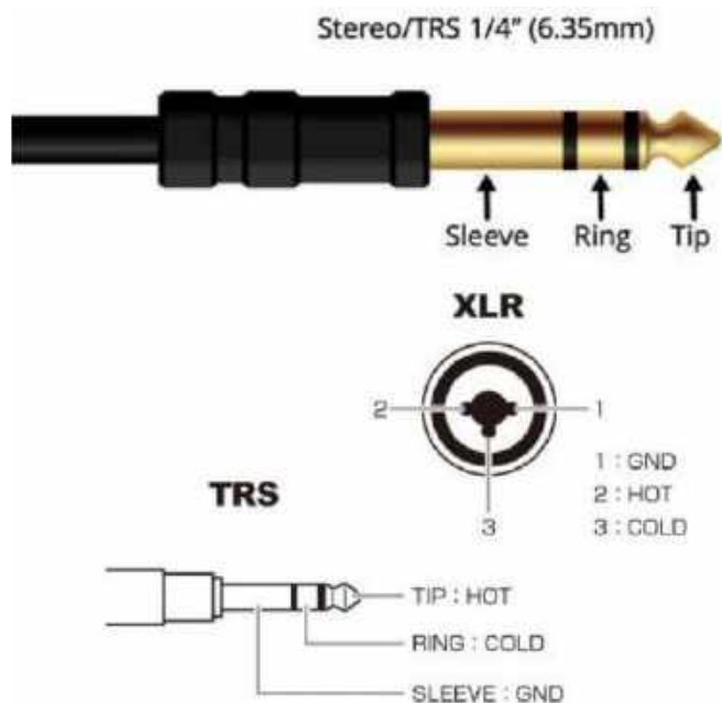
Rysunek 4. Schemat połączeń wtyków TRS i XLR w przypadku sygnałów zbalansowanych
