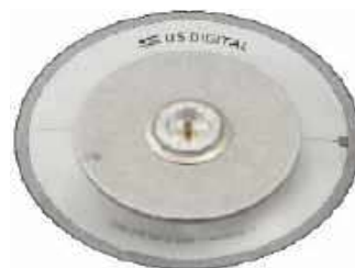
Fotografia 14. Tarcza enkodera inkrementalnego wysokiej rozdzielczości ( http://t.ly/Nsg1i )
