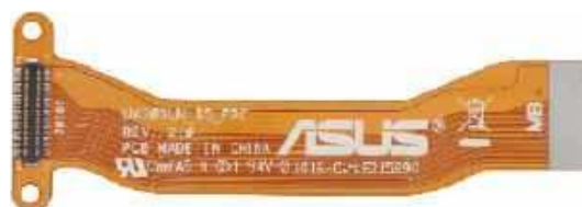
Fotografia 6. Niestandardowy kabel FPC wyposażony w otwory montażowe ( http://tinyurl.com/5yys7kj3 )
