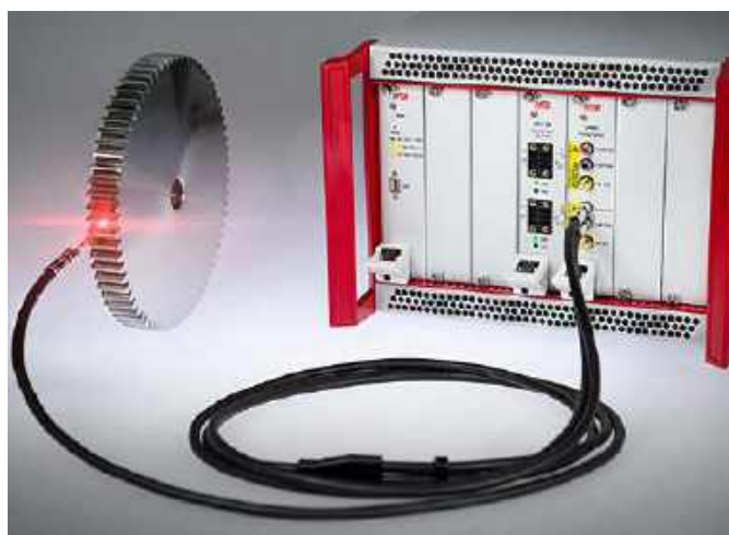
Fotografia 11. Zaawansowany tachometr laserowy marki IFTA Systems ( http://t.ly/XH9B1 )
