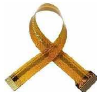
Fotografia 4. Taśma-adapter umożliwiająca podłączanie kamer płytkowych do minikomputerów Raspberry Pi Zero ( http://tinyurl.com/va7htdup )
