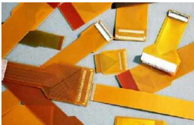
Fotografia 3. Przykładowe adaptory wykonane w technologii FPC ( https://tinyurl.com/4db83v5m )
