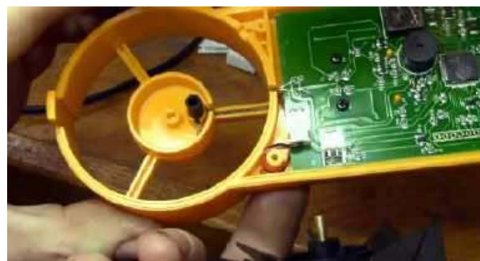
Fotografia 7. Wnętrze obudowy prostego anemometru z widocznym fotoelementem będącym częścią bariery optycznej służącej do odczytu obrotów wiatraczka ( https://tinyurl.com/y9fnwscj )
