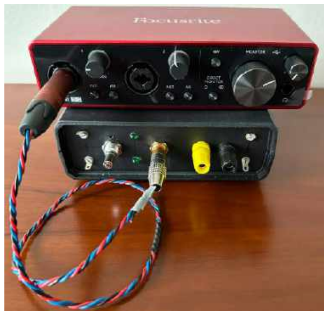
Fotografia 3. Połączenie wejścia karty ze sztucznym obciążeniem
