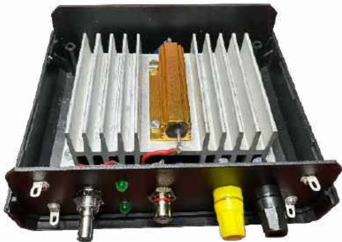
Fotografia 1. Praktyczna realizacja sztucznego obciążenia
