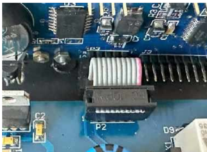
Fotografia 3. Połączenie obu płytek taśmą z wtykiem IDC10
