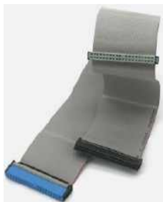
Fotografia 26. Kabel do obsługi dysków twardych i napędów optycznych z interfejsem ATA ( http://tinyurl.com/3zuf5e2b )
