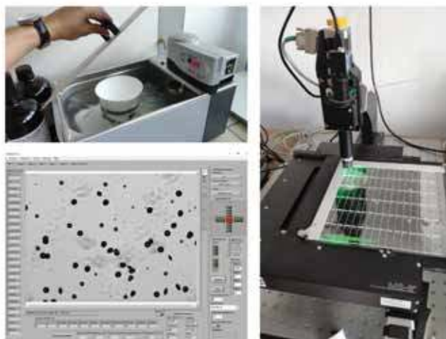
Ilustracja 2. Układ doświadczalny w Centralnym Laboratorium Ochrony Radiologicznej – u góry z lewej termostat, po prawej mikroskop z przesuwnym stolikiem, z lewej na dole obraz spod mikroskopu.
