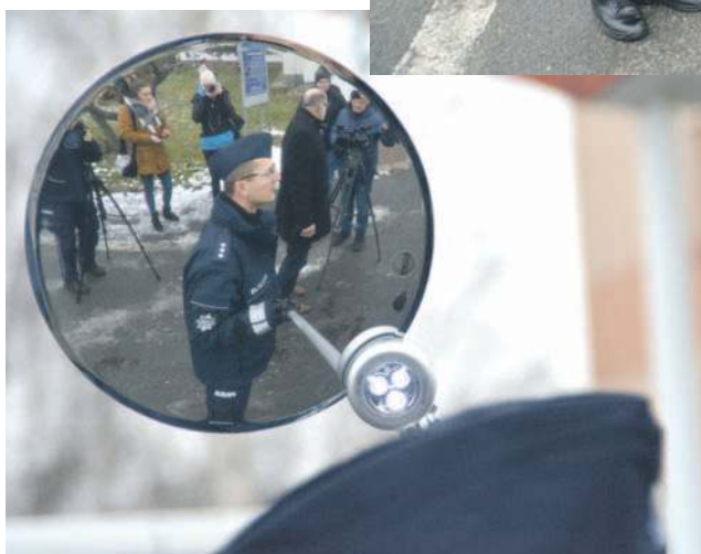
Oświetlenie led pozwala używać lustra do sprawdzenia podwozia samochodu
