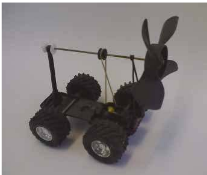
Fot. 1. Przykład wykonania modelu samochodu napędzanego wiatrem z wykorzystaniem elementów starej zabawki i śmigła od wentylatora chłodzącego komputer.
