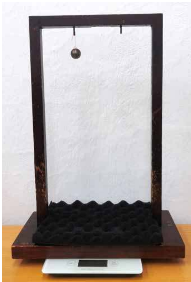
Fot. 2. Przykład układu doświadczenia do wykazania stanu nieważkości spadającej kulki.
