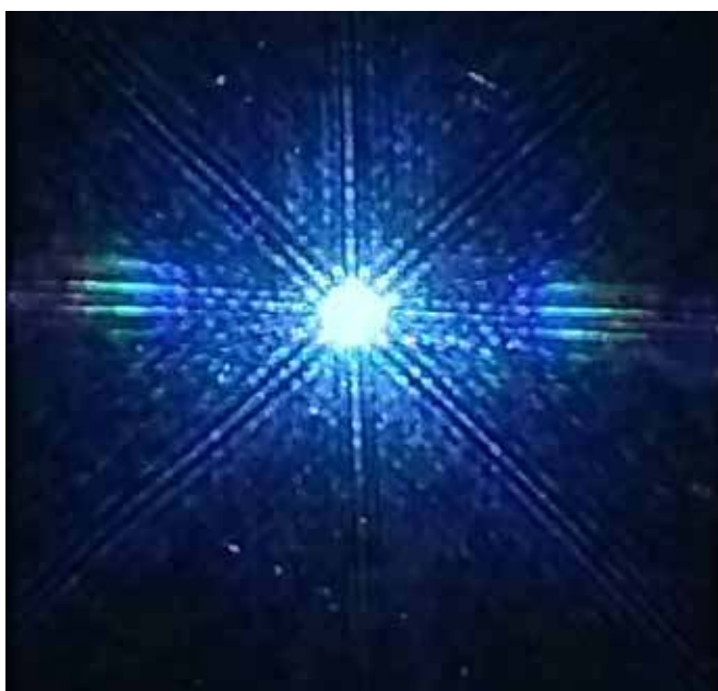
Fot. 8. Obraz otrzymany po oświetleniu ekranu telefonu komórkowego wskaźnikiem laserowym w kolorze niebieskim \lambda = 450 \text{ nm} , (fot. Jerzy Krysiak).
