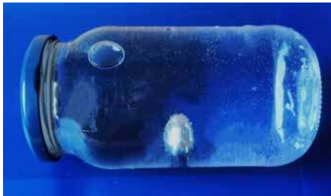
Fot. 1. Przykład wykonania przyrządu z pęcherzykiem powietrza do pokazu pływania w układzie poruszającym się ruchem przyspieszonym. (fot. autor)
