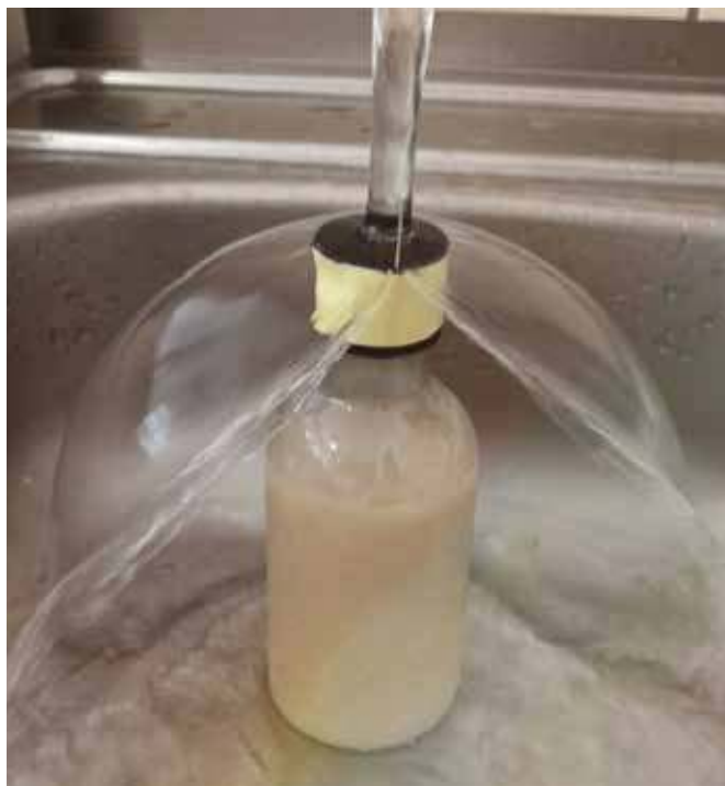
Fot. 5. „Namiocik wodny” spowodowany przez odskok hydrauliczny i rozptyw wody na zakrętce plastikowej butelki od szamponu z ogranicznikiem rozptywu wykonanym z kawałka drutu (fragment spinacza biurowego), przymocowanym taśmą klejącą do brzegu zakrętki.
