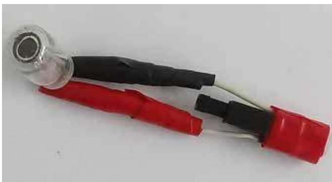
Fot. 3. Mechanizm uderzeniowy przyłączony do neonówki pozwala w efektywny sposób zademonstrować wytworzenie napięcia piezoelektrycznego. Neonówka jest przeznaczona do świecenia po przyłożeniu napięcia sieciowego. Grube warstwy czerwonej izolacji chronią przed mało przyjemnym działaniem napięcia o takiej wielkości na skórę palców.
