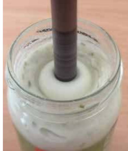
Fot. 7. Wzniesienie cieczy nienewtonowskiej (sos tatarski) spowodowane ruchem obrotowym.
