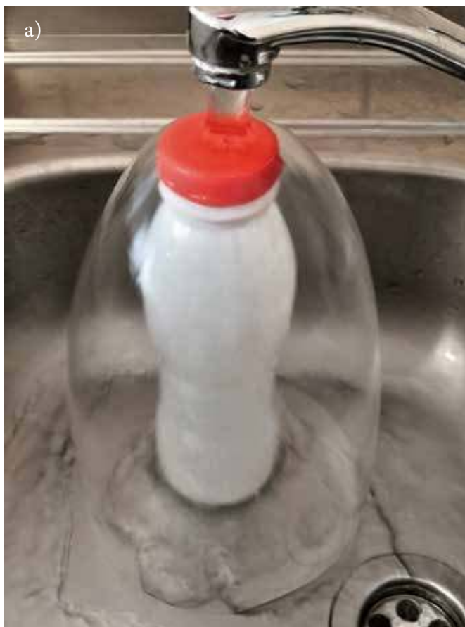
Fot. 7. Zakrzywienie dolnej powierzchni „parasola wodnego” w kierunku osiowym w zależności od prędkości wypływu: a) kształt zbliżony do powierzchni paraboloidy, b) kształt bardziej przypominający fragment powierzchni elipsoidy. Efekt uzyskano w wyniku rozptywu wody po odrzucie hydraulicznym na zakrętce plastikowej butelki od kefiru.
