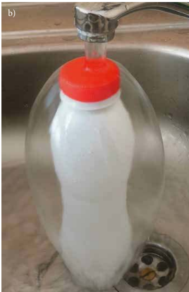
Fot. 7. Zakrzywienie dolnej powierzchni „parasola wodnego” w kierunku osiowym w zależności od prędkości wypływu: a) kształt zbliżony do powierzchni paraboloidy, b) kształt bardziej przypominający fragment powierzchni elipsoidy. Efekt uzyskano w wyniku rozptywu wody po odrzucie hydraulicznym na zakrętce plastikowej butelki od kefiru.
