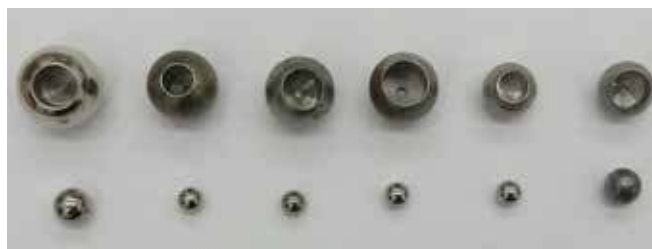
Fot. 2. Przykłady zestawów złożonych z większych kulek z wywierconym otworem i mniejszych kulek przeznaczone do badania zderzeń.
