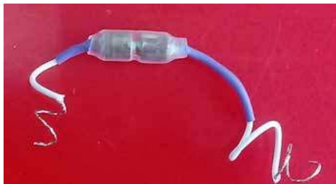
Fot. 5. Wygląd zewnętrzny elementu piezoelektrycznego, połączonego z elektrodami w sposób pokazany na rys. 2.
