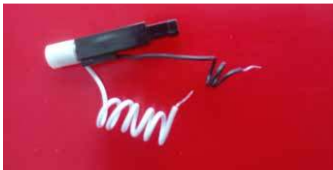
Fot. 2. Wygląd zewnętrzny wymontowanego z zapalarki mechanizmu uderzeniowego, zawierającego kryształ piezoelektryczny.
