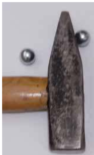
Fot. 2. Wykorzystanie obucha młotka, jako płyty trójkątnej do badania zderzeń.
