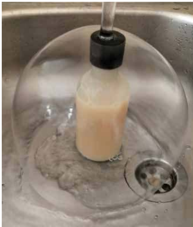
Fot. 2. Odskok hydrauliczny i rozpliw wody na zakrętce plastikowej butelki od szamponu.
