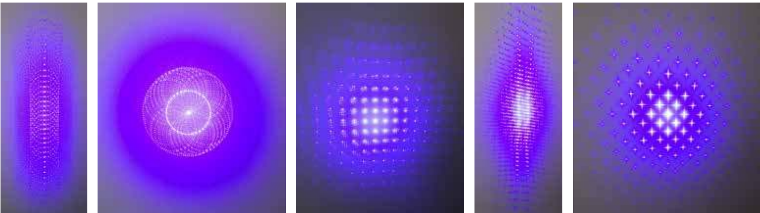
Fot. 12. Przykłady obrazów wytwarzanych na siatkach dyfrakcyjnych, wbudowanych w końcówki lasera dyskotekowego.
