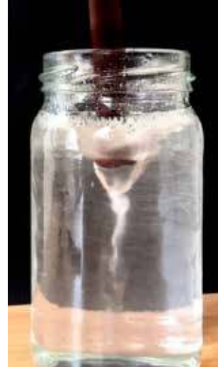
Fot. 6. Zagłębienie w wodzie spowodowane ruchem obrotowym.
