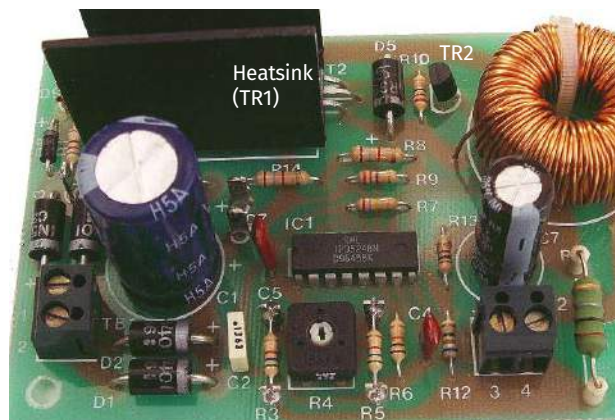
Rysunek 4.6. Prosty niskonapięciowy SMPS.
