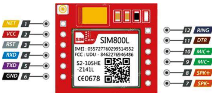
Rysunek 2. Szczegółowe informacje o stykach SIM800L
