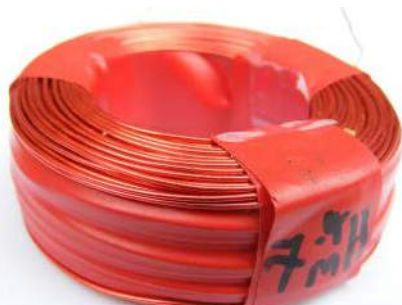
Rysunek 40. Cewka z rdzeniem powietrznym – wymaga wielu zwojów, aby uzyskać wymaganą indukcyjność, co zwiększa koszty i rezystancję. Mają one bardzo małe zniekształcenia i są łatwe do samodzielnego wykonania, jak pokazuje ten przykład. Cewka trzyma się w całości za pomocą czerwonej taśmy izolacyjnej.
