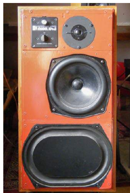
Rysunek 36. KEF 104aB jest jednym z najładniej brzmiących głośników ze względu na gładkie, lekko obniżone średnie tony. Charakteryzuje się także mniejszymi zniekształceniami dzięki krótkiej cewce w długiej szczelinie.
