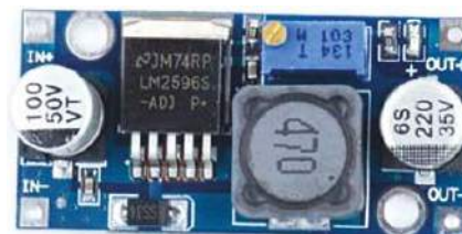
Rysunek 3. Przełącznik buck
