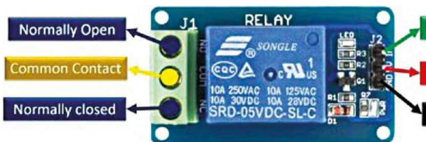
Rysunek 18. Szczegóły pinów modułu przekaźnikowego
