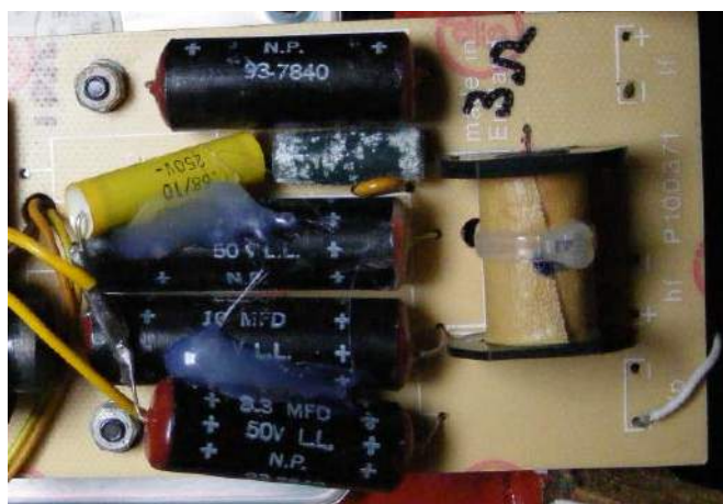
Rysunek 52. Elementy wewnętrzne zwrotnicy KEF 104aB. Zwróć uwagę na kondensatory Callins/Elcap EX50. Są to stare, mokre elektrolytyki, ale uszczelnione epoksydowo, dzięki czemu są trwałe. Powinny być jednak zawsze sprawdzane pod kątem wysokiego ESR i podwyższonych wartości pojemności. W tym przypadku oryginalny element 600 nF został zastąpiony żółtym kondensatorem poliestrowym.
