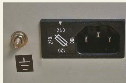
Rysunek 4.18. Bezpiecznikowy selektor sieciowy łączy wybór napięcia sieciowego ze standardową oprawką bezpiecznikową 20 mm i złączem sieciowym IEC (wymagana jest większa wartość prądu znamionowego do pracy przy napięciu 110/120 V). Zauważ zewnętrzny port uzziemienia, który umożliwia połączenie z innymi urządzeniami.
