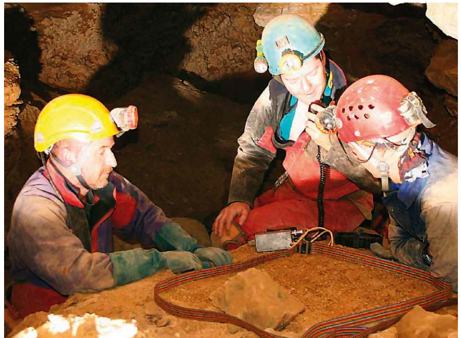
Rysunek 35. Obsługa Molefone w jaskiniach Matienzo, Hiszpania. Zwróć uwagę na antenę pętlową wykonaną z komputerowego przewodu taśmowego. Źródło: http://matienzocaves.org.uk/ugpics/2366-2007e-molep.htm
