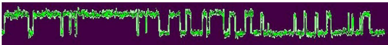
Szum impulsowy (burst noise) uwidoczniony na oscylogramie (© 2022 Jos Verstraten)
