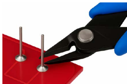
Rysunek 7. Właściwe miejsce cięcia nadmiaru wyprowadzeń po przylutowaniu komponentu. Po wykonaniu cięcia spoina powinna pozostać nienaruszona
