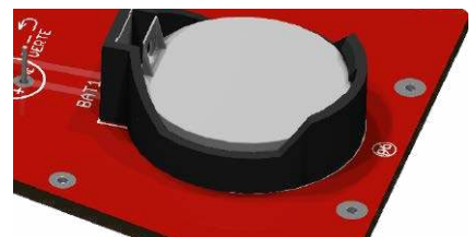
Rysunek 1. Bateria CR2032 zamontowana w przeznaczonym dla niej gnieździe na tylnej ścianie każdej z figurek. Bateria taka łatwo może zostać przez małe dziecko zdemonstrowana i połknięta, dlatego przed udostępnieniem zabawki dziecku przeczytaj koniecznie akapit „Bawmy się i uczmy bezpiecznie” i zachowaj ostrożność
