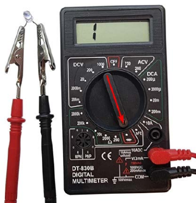
Fotografia 7. Sprawdzanie diody LED za pomocą multimetru ustawionego na funkcję testowania diod. Po przyłożeniu sondy czerwonej do anody, a czarnej do katody, sprawna dioda LED powinna się zaświecić. Jeśli dioda ma odpowiednio długie (jeszcze nie przycięte) wyprowadzenia można się wspomóc krokodylkami
