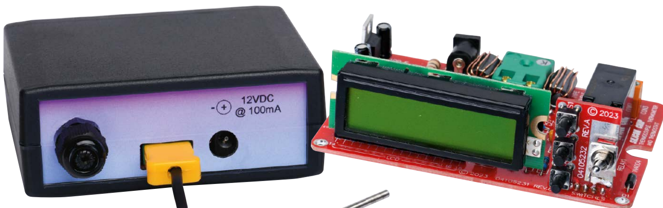
Tył obudowy z podłączoną termoparą typu K
