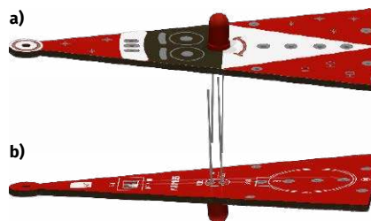
Rysunek 5. a) obudowa diody LED stanowi nos Mikotaja, stąd znajduje się po stronie jego twarzy; b) wyprowadzenia diody LED skierowane są w stronę spodu, gdzie w następnym etapie zostaną zamontowane przełącznik oraz koszyczek z baterią CR2032
