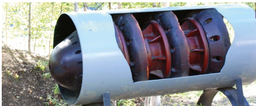
Rysunek 53. Pig czyszczący rurociąg w wyciętym odcinku rury. Niektóre mają elektronikę i komunikują się na częstotliwości 22 Hz. Źródło: https://w.wiki/6Exp (CC BY-SA 2.0)
