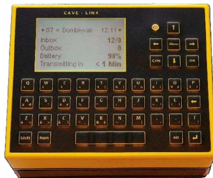
Rysunek 37. Terminal Cave-link do wysyłania danych tekstowych przez VLF przez ziemię. Źródło: https://expo.survex.com/expofiles/documents/hardware/Cavelink2.13_en_2014-3.pdf
