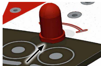
Rysunek 9. Przykład poprawnie zamontowanej diody LED. Płaskie ścieżki na obwodzie podstawy diody LED, symbolizujące katodę, musi pokrywać się z fragmentem linii prostej w obrysie diody LED widocznym po drugiej stronie płytki PCB (rysunek 4)
