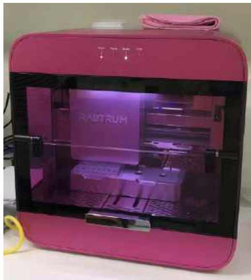
1. Biodrukarki umożliwiają precyzyjne rozmieszczenie komórek w trójwymiarowej strukturze
