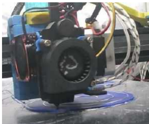
7. Kadr z filmu prezentującego druk obwodów elektrycznych z Cu-29 © Kupros
