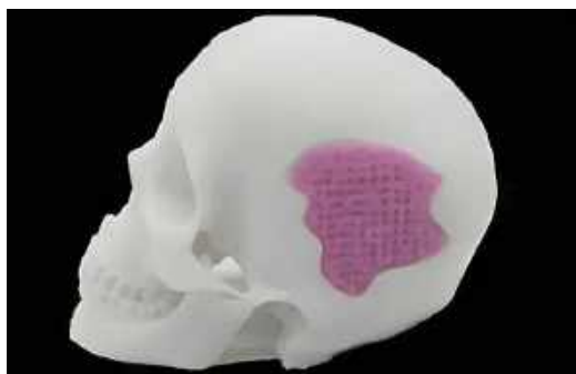
5. Bioaktywne szkło nadające się do druku 3D (na różowo) może być wykorzystane jako substytut kości
