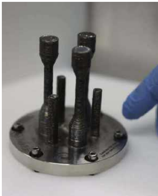
9. Pierwsza metalowa część 3D, jaką kiedykolwiek stworzono na orbicie © ESA
