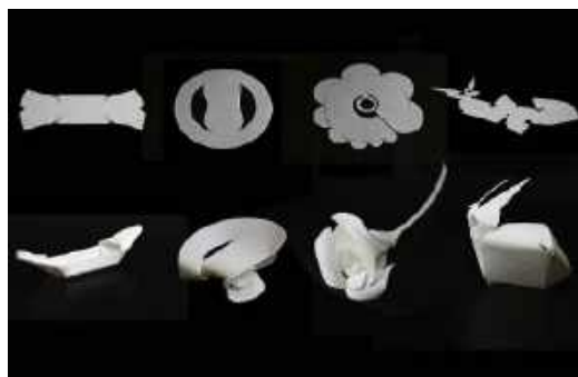
10. Modelowe przedstawienie druku 4D, czyli przeobrażeń drukowanego w 3D obiektu w czasie
