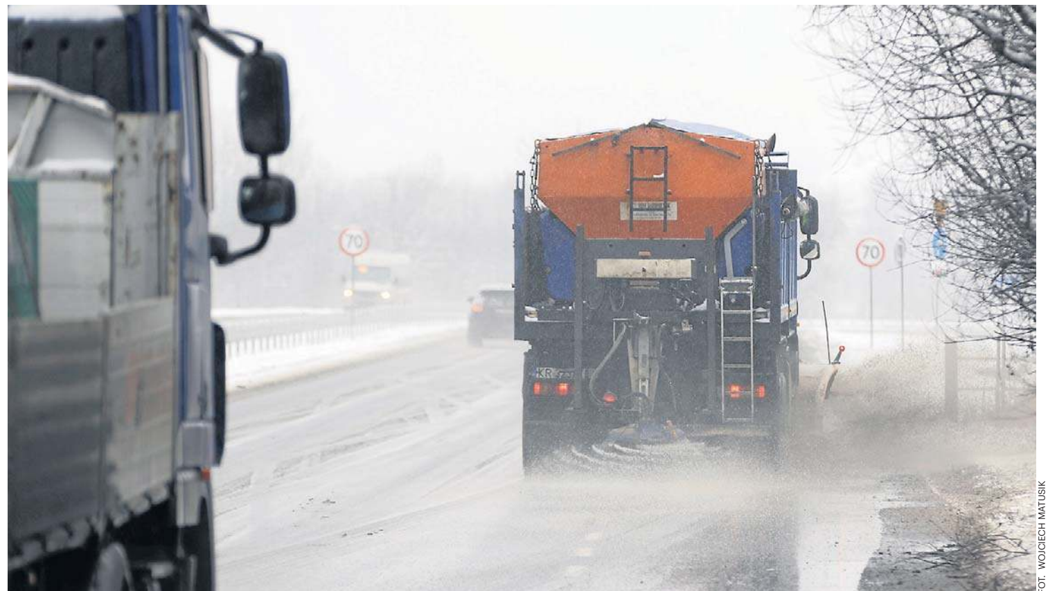
Sól drogowa, używana do odladzania, to chlorek sodu (NaCl) z dodatkami, który obniża temperaturę zamarzania wody, ale jest też główną przyczyną korozji samochodów. Rzadziej przez drogowców stosowany jest chlorek wapnia oraz chlorek magnezu
