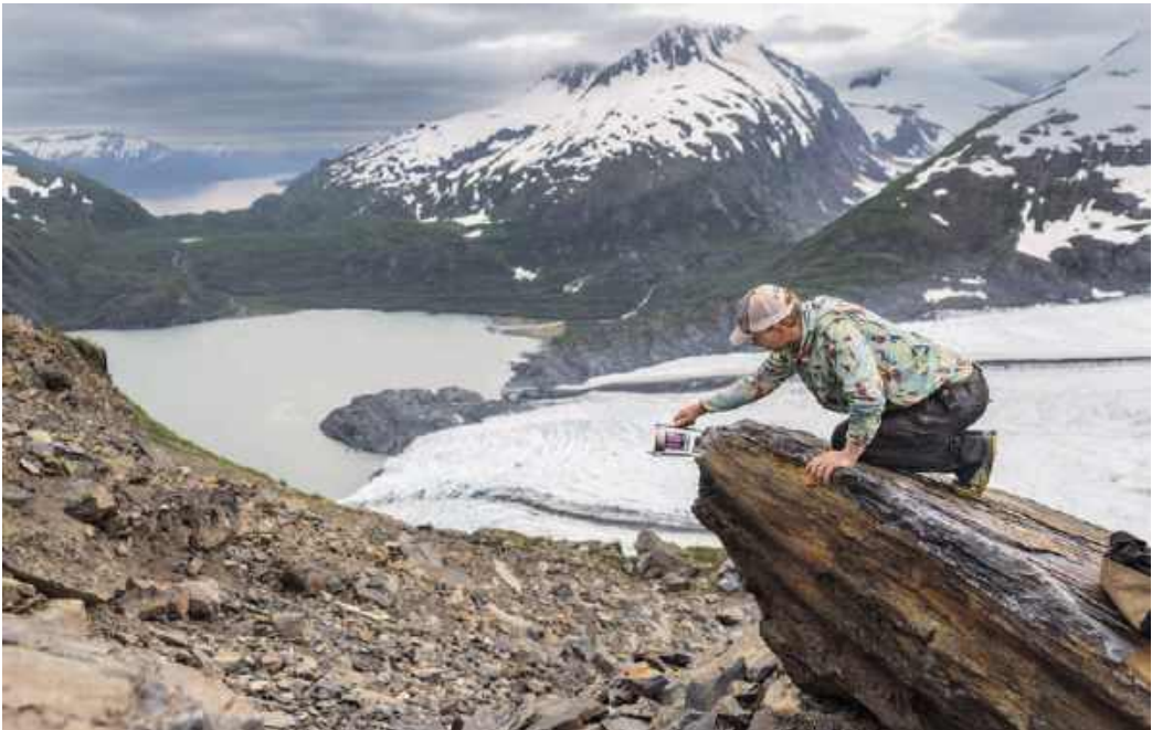
Radar Higa, kosztujący 300 dol., umieszczony w słoiku, odbija sygnał od pobliskiej płyty reflektorowej, co pozwala monitorować ruch osuwiska. Czujnik przesyła następnie dane bezprzewodowo.
