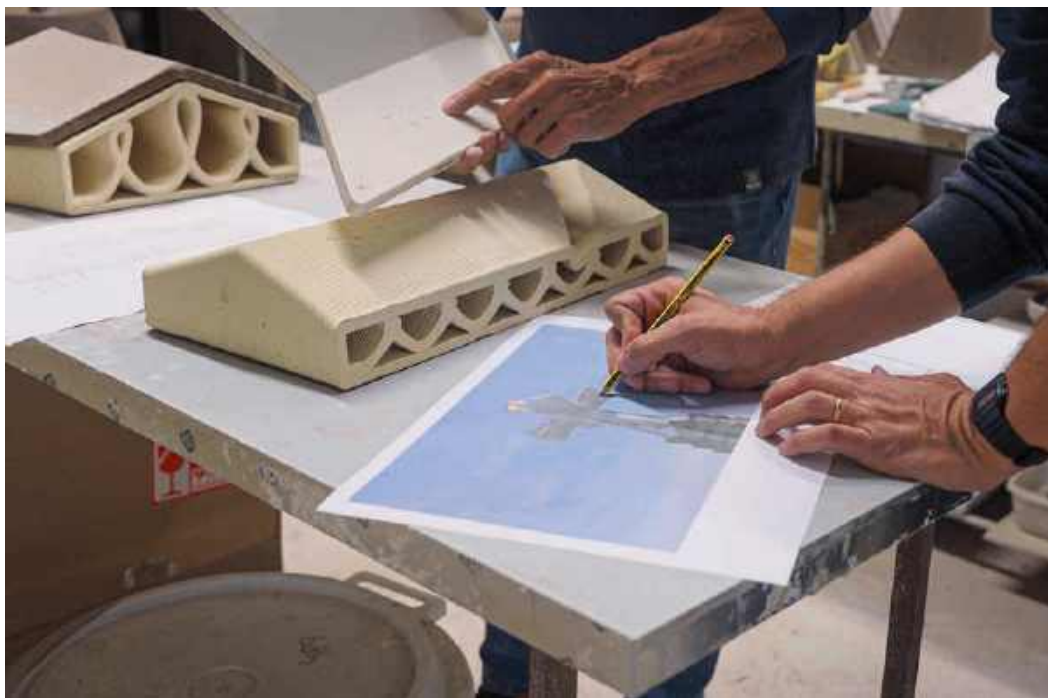
Ceramicy z rodziny Cumella wykonali 13 060 elementów zewnętrznej powłoki krzyża na Wieży Jezusa Chrystusa. Użyli 300 różnych form. Prace odbyły się w zakładzie Quant w miejscowości La Jonquera w prowincji Girona.
