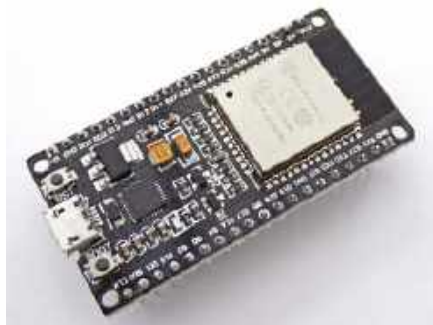
Rysunek 1. W przeciwieństwie do modułów Raspberry Pi Pico i Arduino Uno, płytka rozwojowa ESP32 NodeMCU oferuje możliwość skorzystania z dwóch wewnętrznych przetworników cyfrowo-analogowych. Niestety, zapewniają one tylko 8-bitową rozdzielczość, więc możliwe jest uzyskanie tylko 256 poziomów napięcia wyjściowego
