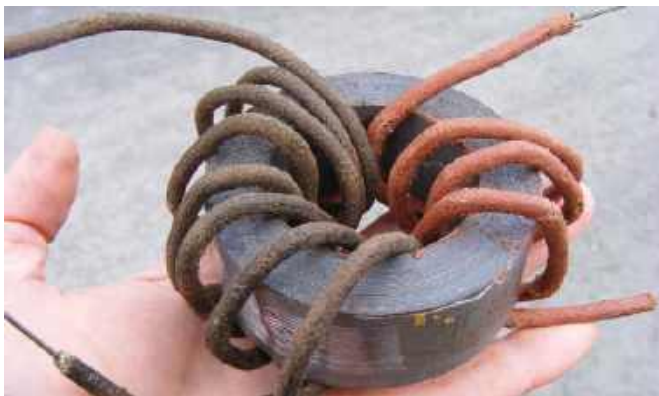
Rysunek 1. Rekonstrukcja oryginalnego transformatora Faradaya. Dwie cewki na żelaznym pierścieniu. Przewód izolowany tkaniną pochodzi spod desek podłogowych mojej plebanii z 1901 roku. Duchowni byli wówczas na bieżąco z nowościami techniki
