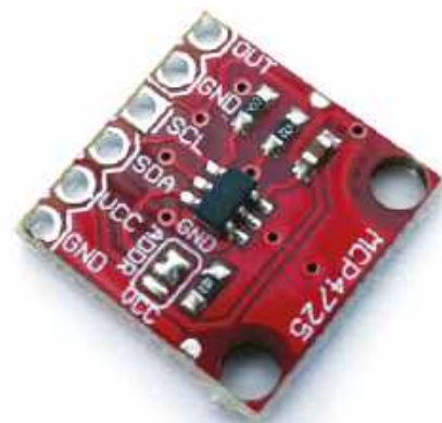
Rysunek 9. Tani moduł przetwornika cyfrowo-analogowego oparty na układzie MCP4725
