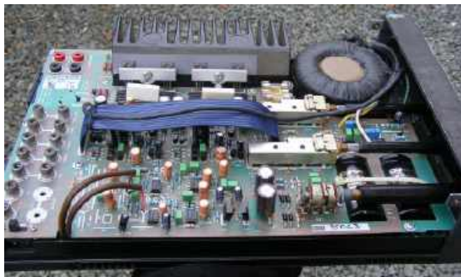
Rysunek 2. Transformator Faradaya jest nadal stosowany, choćby w nowoczesnych wzmacniaczach audio. U góry po prawej stronie mamy toroid 28-0-28 V 100 VA we wzmacniaczu Cyrus 2 firmy Holden and Fisher
