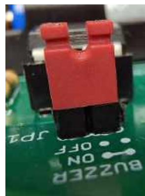
Fotografia 14. Złożenie czerwonej zworki z czarnym złączem typu goldpin 1x2, gotowe do wlotowania w płytkę PCB
