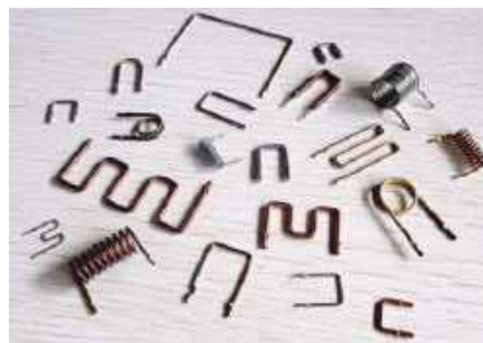
Specjalne rezystory bocznikowe o bardzo niskiej impedancji (© Kang Yoxin Electronics)
