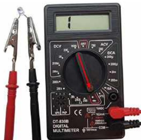
Fotografia 10. Sprawdzenie diody LED za pomocą multimetru ustawionego na testowanie diod. Po przyłożeniu sondy czerwonej do anody, a czarnej do katody, sprawna dioda LED powinna się zaświecić. Jeśli dioda ma odpowiednio długie (jeszcze nie przycięte) wyprowadzenia można się wspomóc krokodylkami
