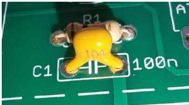
Fotografia 7. Montaż kondensatora ceramicznego C1. Kierunek montażu jest obojętny. Na obudowie kondensatora widać napis „104” informujący o pojemności 10 i 4 zera pikofaradów (100000 pF), czyli 100 nF
