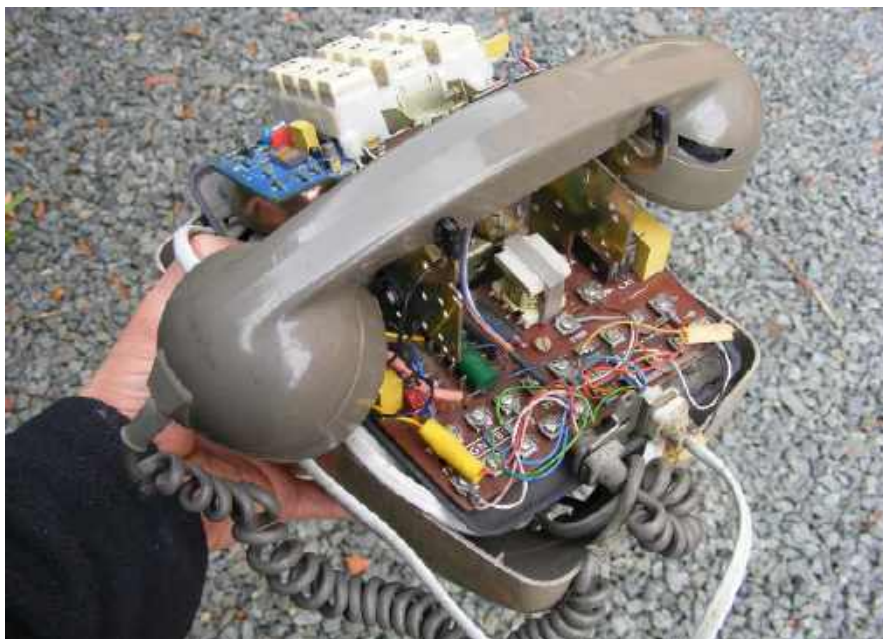
Rysunek 4. Pierwsze zastosowania transformatorów w elektroakustyce miały miejsce w aparatach telefonicznych. Transformatory były w nich używane jeszcze całkiem niedawno. Na zdjęciu: aparat British Telecom z 1981 roku. Transformator służył do dopasowania impedancji i częściowej eliminacji dźwięku lokalnego (własnego głosu w słuchawce)
