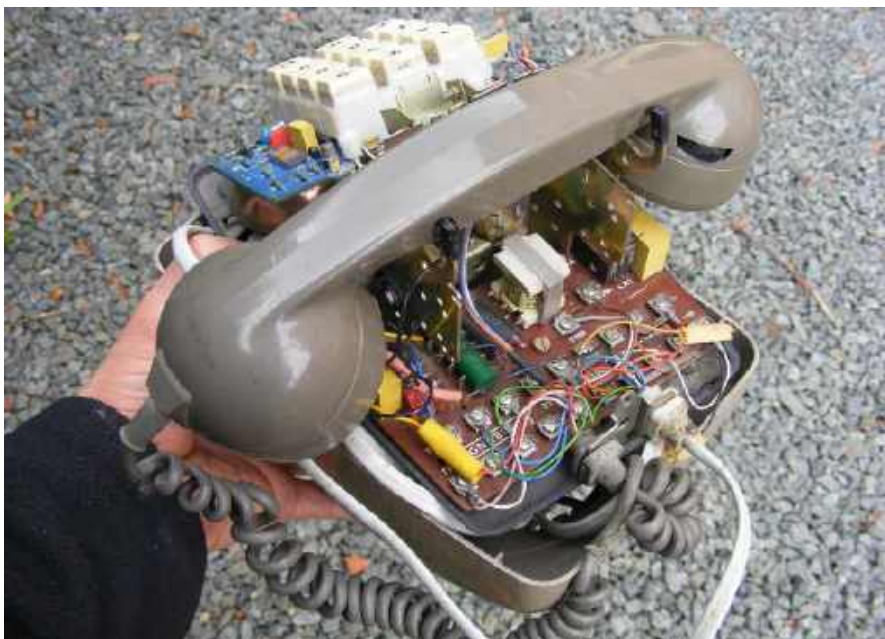
Rysunek 4. Pierwsze zastosowania transformatorów w elektroakustyce miały miejsce w aparatach telefonicznych. Transformatory były w nich używane jeszcze całkiem niedawno. Na zdjęciu: aparat British Telecom z 1981 roku. Transformator służył do dopasowania impedancji i częściowej eliminacji dźwięku lokalnego (własnego głosu w słuchawce)
