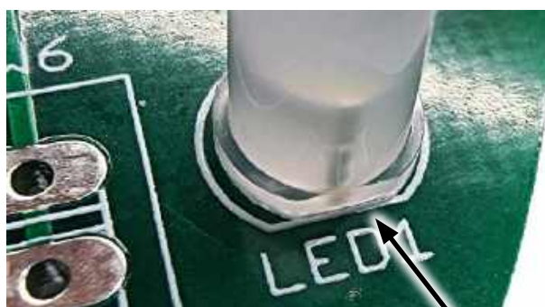
Płaskie ścięcia na obwodzie diody LED to katoda
