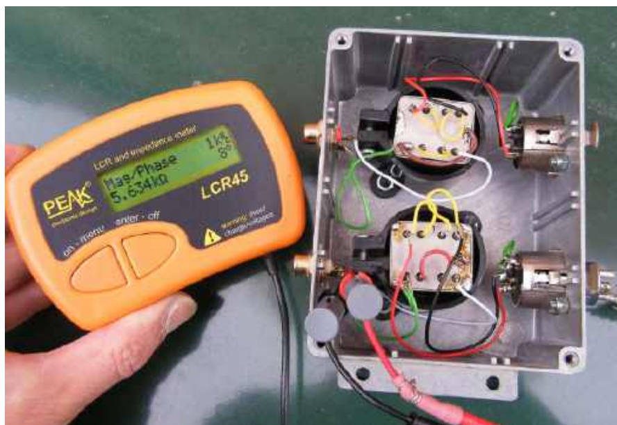
Rysunek 5. Do sprawdzania działania transformatora bardzo się przydaje miernik impedancji. Na zdjęciu: układ z transformatorem 14:1 (Vigortronix VTX-101-003), przekładający małą impedancję (22 Ω) wyjścia przetwornika gramofonowego z ruchomą cewką na impedancję 5 kΩ
