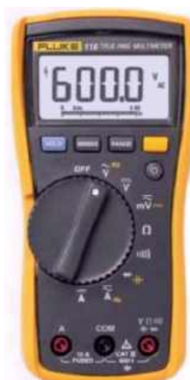
Multimetr z automatycznym przełączaniem zakresów pomiarowych (© Fluke)
