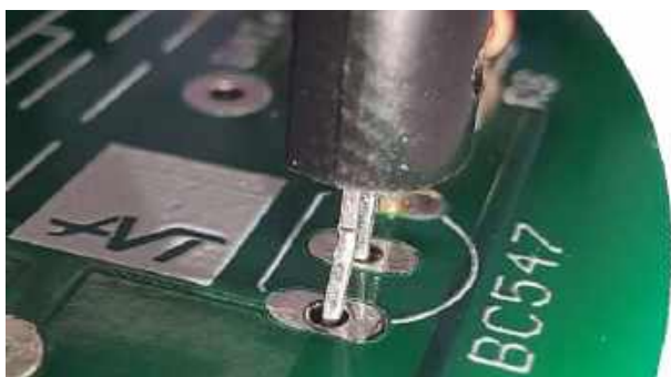
Fotografia 11. Poprawny montaż tranzystora T2. Tranzystor T1 należy przylutować w taki sam sposób. Korpusy tranzystorów (w kształcie litery „D”) odpowiadają obrysom (również w kształcie litery „D”) na warstwie opisowej płytki PCB
