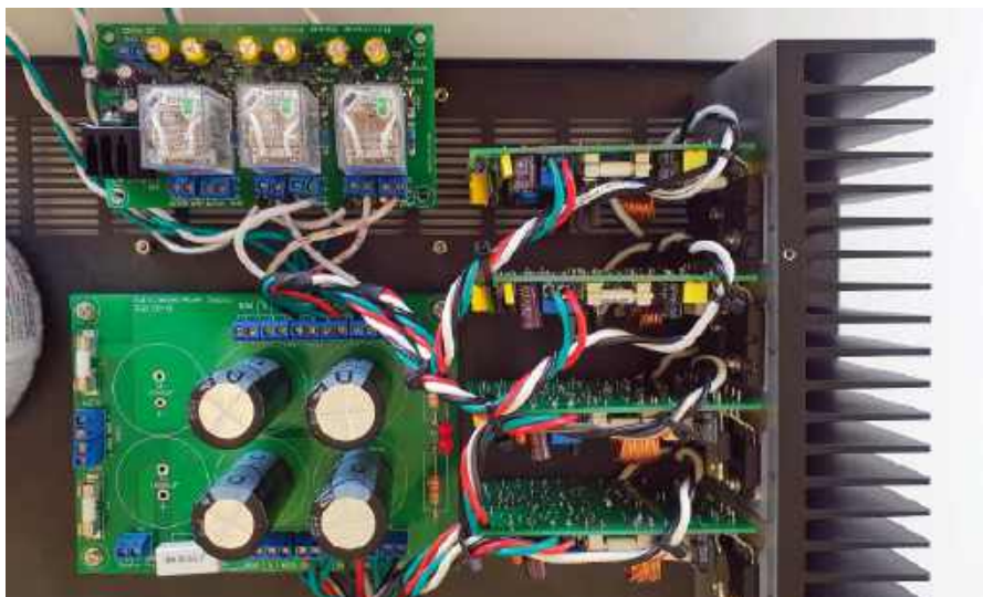
Fotografia 13. Podłączenie przewodów do modułu zabezpieczenia głośników najlepiej wykonać przed jego ostatecznym zamocowaniem w obudowie. Aby zyskać więcej miejsca podczas tej czynności, warto na czas montażu zdemonstrować tylny panel
