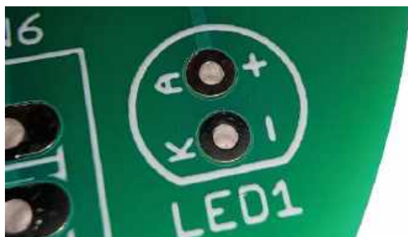
Fotografia 8. W otwory oznakowane literą „A” lub znakiem „+” należy zamontować anody (dłuższe wyprowadzenia diod LED), natomiast katody (krótsze wyprowadzenia diod LED) należy umieścić w otworach oznakowanych literą „K” lub znakiem „-”. Lokalizację katod wskazuje dodatkowo linia prosta w obrysie diody LED
