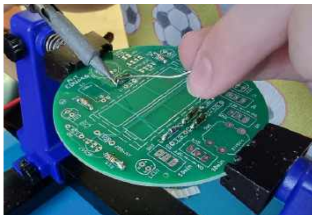
Fotografia 4. Zaproponowany przez Dawida montaż rezystorów możliwy jest w przypadku płytek z miedzią po obu stronach. Lutowanie komponentów „od góry” – w płytce zamontowanej poziomo w uchwycie – umożliwia pominięcie zaginania wyprowadzeń komponentów oraz zapewnia wygodną przestrzeń roboczą. Młodzi Entuzjaści Elektroniki, Szkoła Podstawowa nr 86, Wrocław
