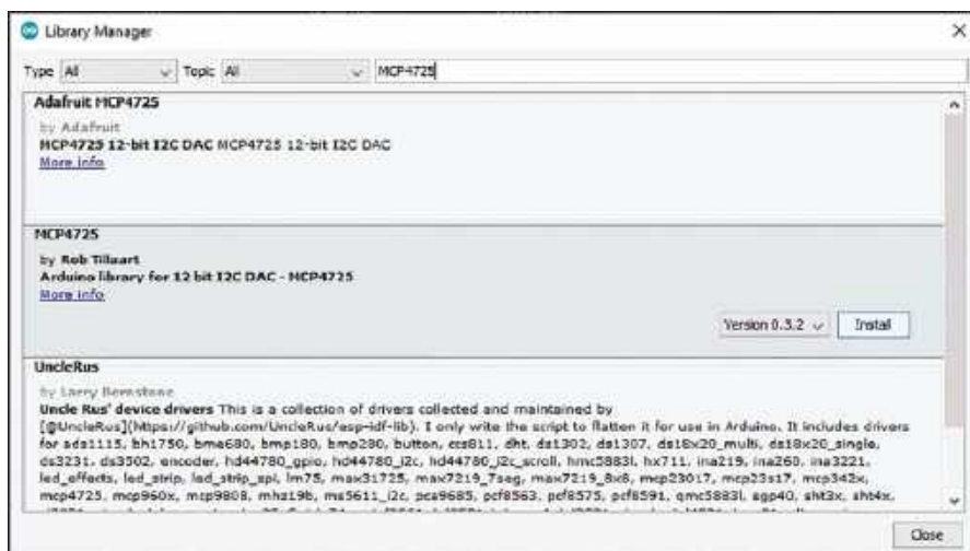
Rysunek 12. Użycie menedżera bibliotek Arduino do zlokalizowania i zainstalowania biblioteki obsługującej układ MCP4725
