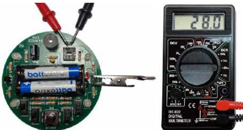
Fotografia 26. Pomiar prądu płynącego przez buzzer. Mikrokontroler został uprzednio wyciągnięty z podstawki, krokodylek zwiiera kolektor i emiter tranzystora T2, sondy miliamperomierza zostały przyłożone do pinów złącza zworki JP2
