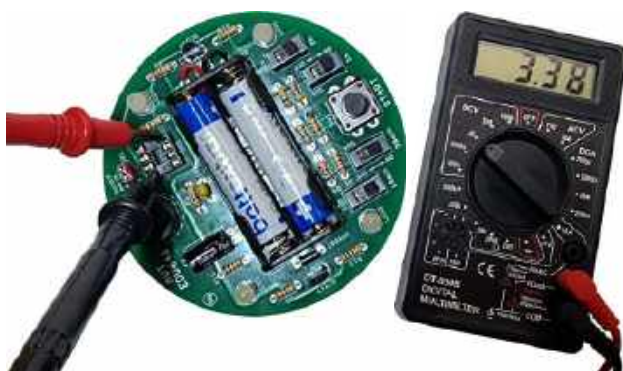
Fotografia 22. Pomiar na zaciskach 8 („plus”) i 4 („minus”) podstawki pod mikrokontroler ATTiny13A wskazał poprawne napięcie baterii (bez znaku „-”, który sugerowałby błędną polaryzację). Można teraz odłączyć zasilanie i zamontować mikrokontroler w podstawce
