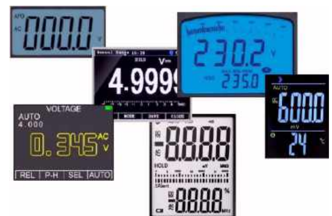
Przykładowe wyświetlacze stosowane w multimetrach (© 2023 Jos Verstraten)
