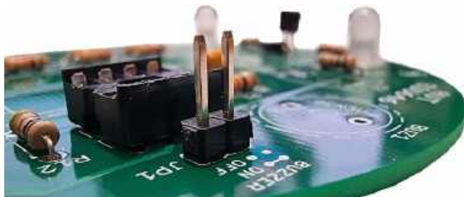
Fotografia 15. Poprawnie zamontowane złącze goldpin
