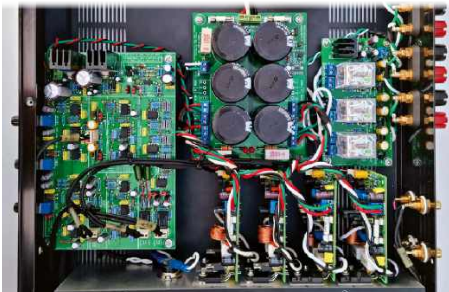
Fotografia 15. Zbliżenie ukazujące szczegóły kompletnego okablowania sygnałowego oraz niskonapięciowego zasilania DC
