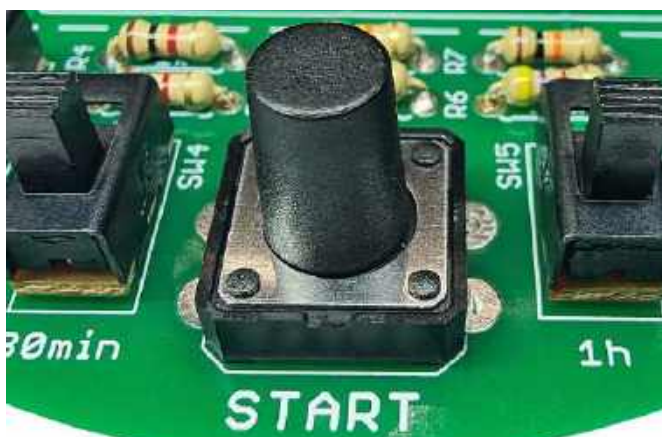
Fotografia 19. Poprawny montaż przycisku start. Wszystkie nóżki przycisku przeszły przez otwory na PCB, a podstawa przycisku przylega bezpośrednio do powierzchni PCB
