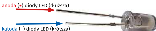
Rysunek 2. Opis wyprowadzeń diody LED („plusowe” wyprowadzenie dłuższe, „minusowe” krótsze)
