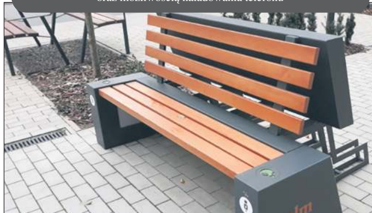
Przykład ławki solarnej połączonej ze stojakiem na rowery oraz możliwością naładowania telefonu
