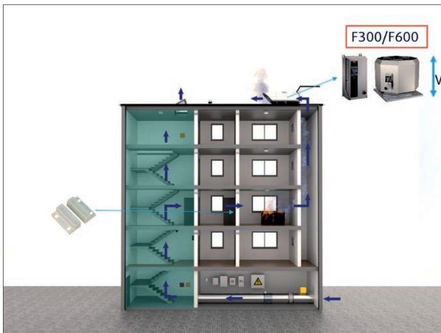
Rys. 1. Schemat regulacji aktywnego upustu powietrza od sygnału otwarcia drzwi – system SMOKE-AXC firmy Systemair Źródło: Systemair
