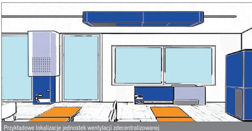
Przykładowe lokalizacje jednostek wentylacji zdecentralizowanej
