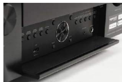
Aranżacja frontu jest klasyczna dla wzmacniaczy AV – dwa pokrętki, duży wyświetlacz, pozostałe wyposażenie pod klapką.
