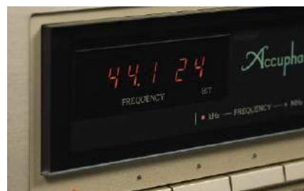
Lewa sekcja wyświetlacza przetwornika wskazuje parametry sygnału na wejściu.
