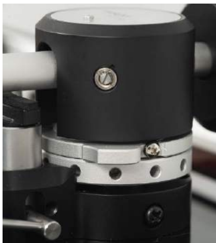
Pierścienie w dolnej części pozwalają na zmianę wysokości kolumny.
