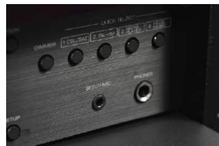
AVC-X4800H ma wyjście słuchawkowe (gniazdo 6,3 mm), a także moduł Bluetooth.
