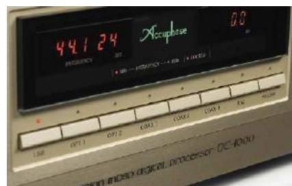
Do wyboru wejść służy aż osiem przycisków – właśnie tyle źródeł możemy podłączyć.
