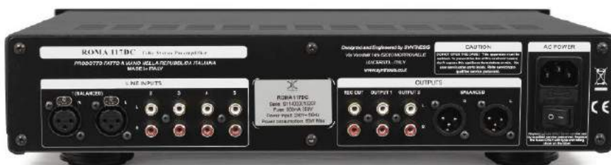
Wejścia i wyjścia podzielono między dwa bloki.
