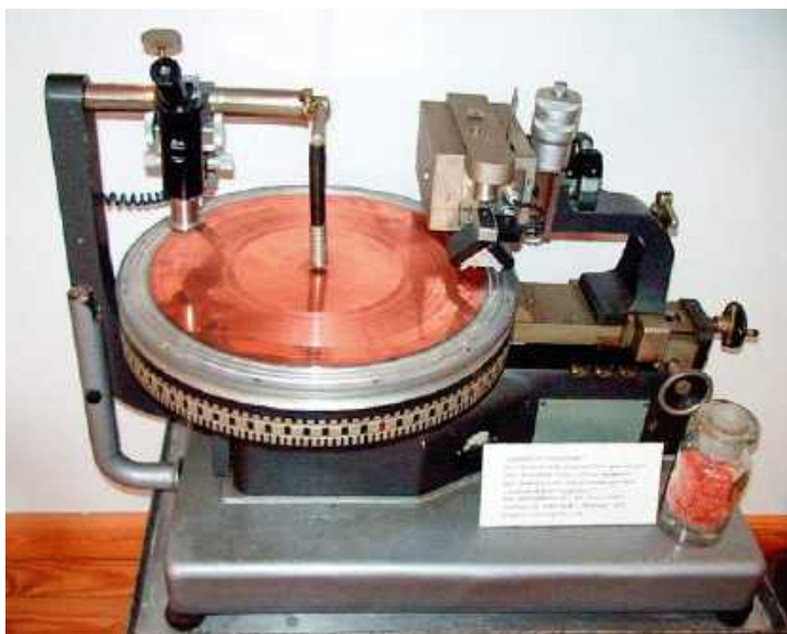
Maszyna do tworzenia matryc płyt drobnowłokowych marki Neumann.
