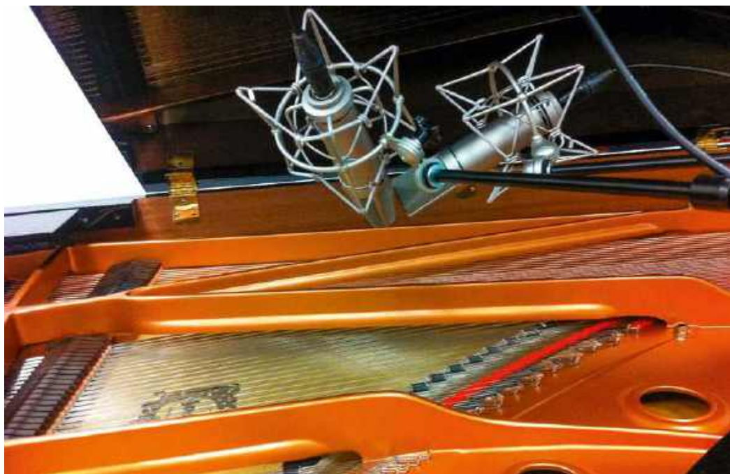
Rzadziej przy bliskim omikrofonowaniu nagrywanego fortepianu niektórzy realizatorzy wybierają technikę X/Y.
