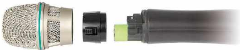
Odkręcając górny pierścień nadajnika ACT-24HC dostajemy się do pojemnika na dedykowany akumulator ICR 18500.
