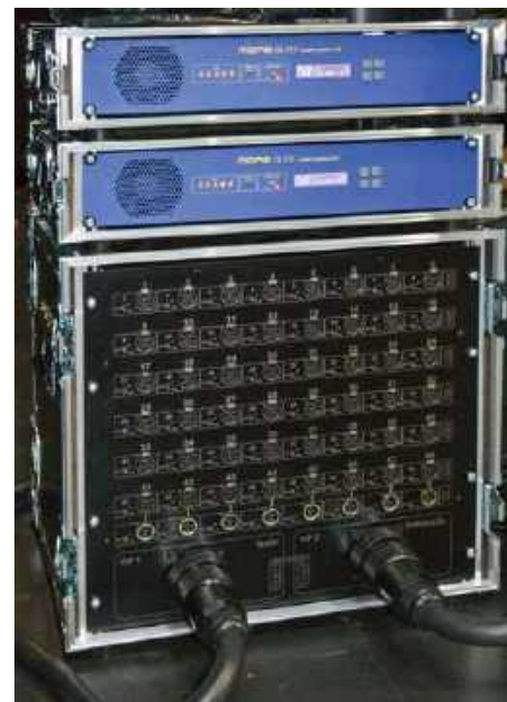
Konsoly współpracują z dwoma stageboxami DL151. Ośrodek dysponuje również analogowym 48-kanalowym splitterem firmy Klotz.
