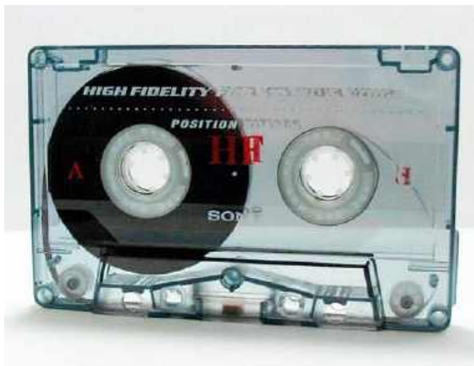
Opracowany standard kasety magnetofonowej określał szerokość taśmy magnetycznej umieszczonej wewnątrz kasety jako 3,81 mm oraz prędkość jej przesuwu wynoszącą 4,76 cm/s.
