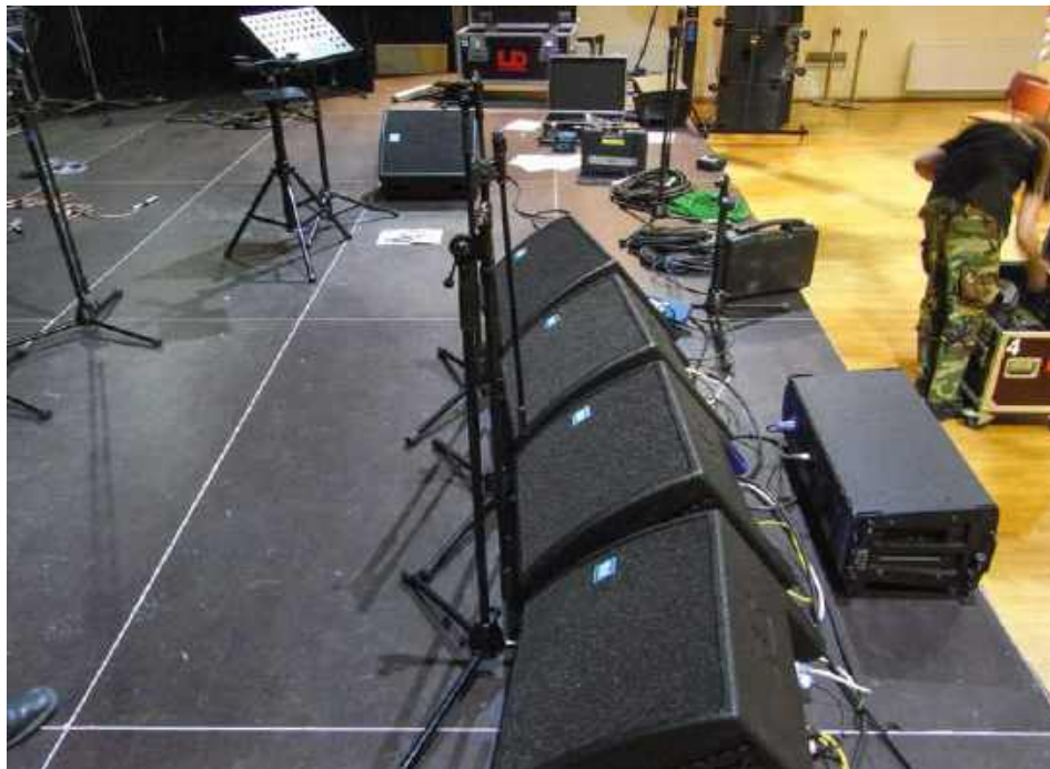
Firma wykorzystuje na imprezach wyłącznie aktywne, koaksjalne monitory własnej produkcji.
