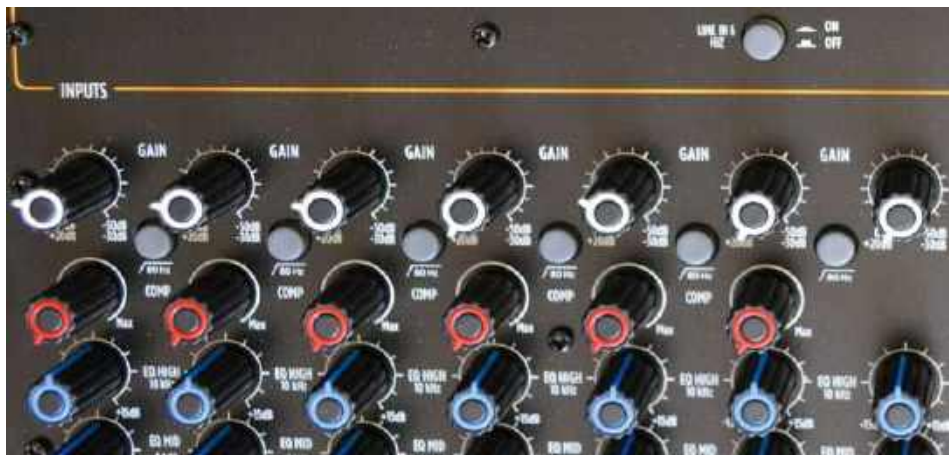
Zaraz za przedwzmacniaczem pracuje filtr górnoprzepustowy, a kolejnym elementem toru monofonicznego – ale tylko pierwszych 6 – jest jednogałkowy kompresor.
