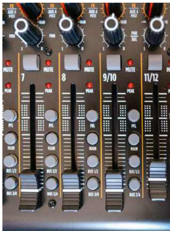
Ostatni potencjometr to regulator panoramy (w kanałach mono), poniżej którego znajduje się 60-milimetrowy potencjometr poziomu sygnału danego kanału (tłumik), z wyłącznikiem mutowania, PFL i komutacji.
