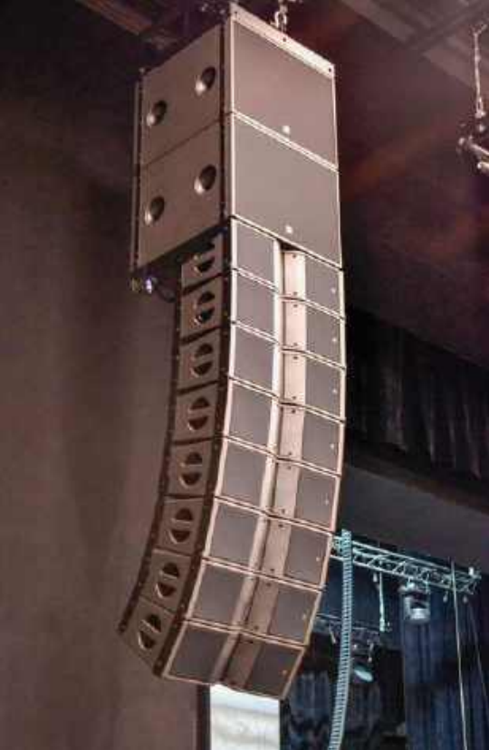
Nagłośnienie główne stanowią dwa klastry składające się z 8 modułów L-Acoustics KARAI i 2 subbasów SB18i.
