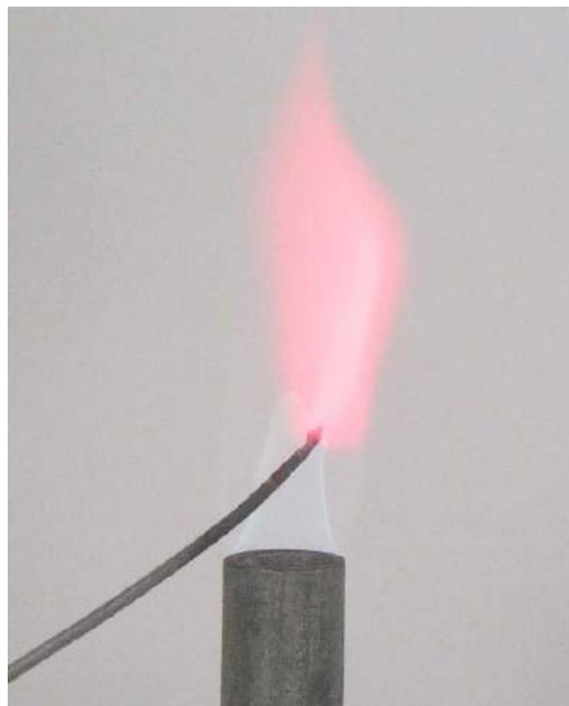
6. Lit w płomieniu palnika.
