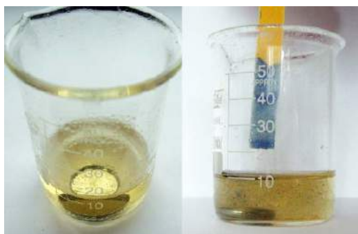
7. Po lewej: roztwarzanie litu w wodzie (na dnie zlewki widoczny fragment obudowy ogniwa). Po prawej: niebieski kolor papierka wskaźnikowego świadczy o zasadowym odczynie otrzymanego roztworu wodorotlenku litu.
