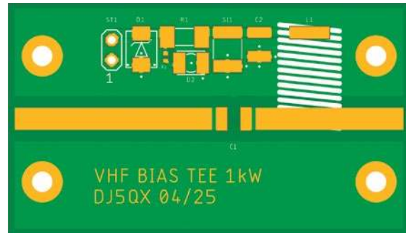
Rys. 4. Schemat montażu rozdzielacza prądu stałego, oryginalne wymiary 51 mm x 30 mm
