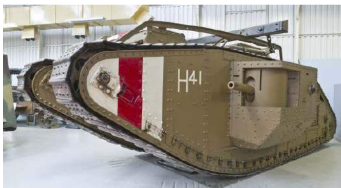
Fotografia 1. Brytyjski czołg Mark V, widoczny jeden ze sponsonów bocznych z własnym działem i szczelinami obserwacyjnymi. Źródło: Wikimedia Commons
