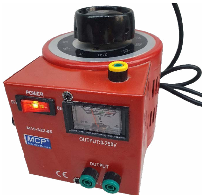
Fotografia 8. Regulowany autotransformator laboratoryjny (wariak)
