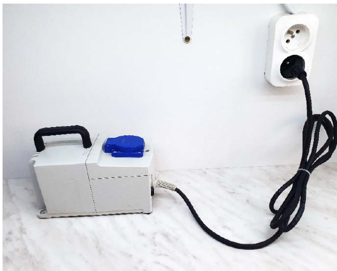
Fotografia 7. Transformator separacyjny 230 V do bezpiecznych pomiarów układów sieciowych
