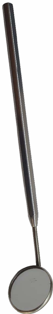
Fotografia 1. Lustro stomatologiczne w metalowej oprawie do inspekcji trudno dostępnych stref montażu
