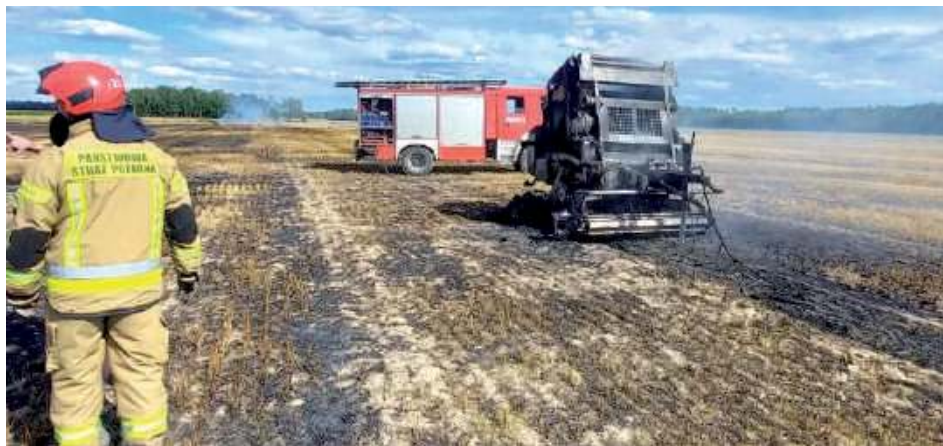
Pożarem objęty był teren o powierzchni 5 hektarów. Prasa rolnicza zapaliła się prawdopodobnie od rozgrzanych części maszyny
