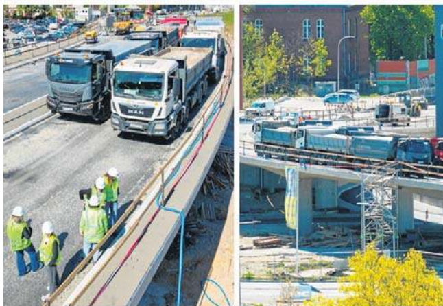
To jeden z kluczowych momentów inwestycji. Ciężkie TIR-y dokonały próbnego obciążenia nowego obiektu.
