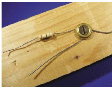
Rysunek 4. Technika łączenia śrubowo/podkładkowego pomysłu George'a Dobbsa
