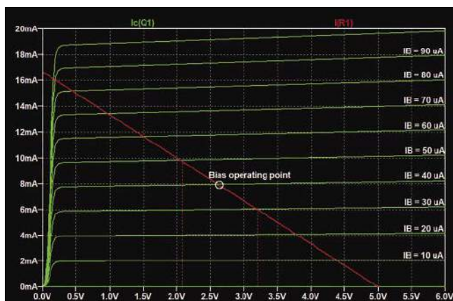
Rysunek 8. Prosta obciążenia dla obwodu z tranzystorem bipolarnym z rysunku 9. Wykres przedstawia zmianę prądu kolektora ( I_C ) w funkcji napięcia kolektor-emitery ( U_{CE} ) przy różnych prądach bazy ( I_B ). Punkt pracy obwodu się przesuwa wzdłuż prostej obciążenia gdy zmienia się prąd bazy i wskazuje też sdpczynkowy punkt pracy (tj. bez sygnału)
