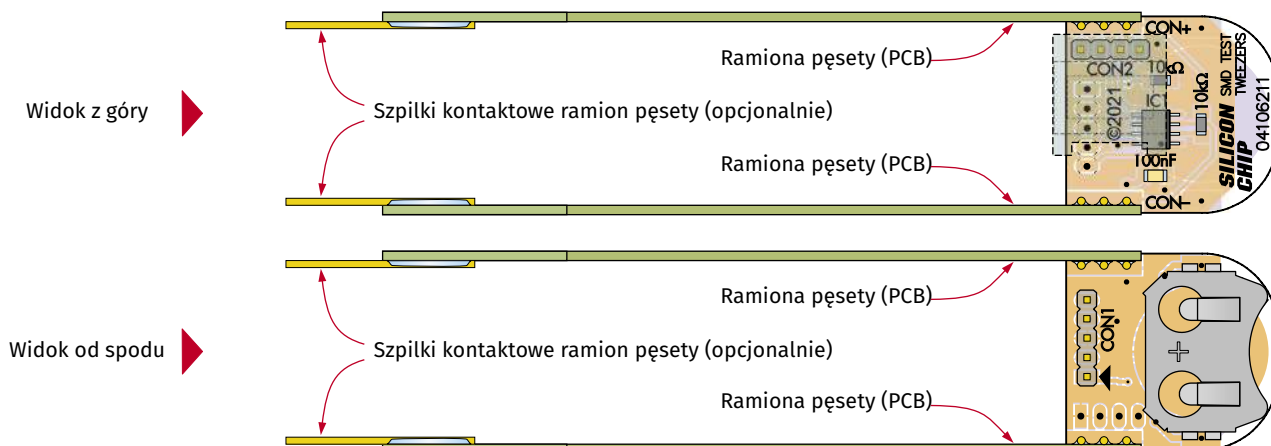
Rysunek 3. Pomimo obecności tylko kilku komponentów, wykorzystaliśmy obie strony płytki drukowanej. Jedną z zalet komponentów SMD, w porównaniu z częściami przewlekаныmi, jest to, że znacznie łatwiej jest mieć części po obu stronach bez obawy o to, gdzie idą przewody. Zwróć uwagę na orientację układu IC1; po jego zamontowaniu reszta montażu jest dość prosta
