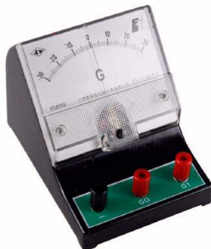
Galwanometr jest przydatny podczas wykonywania pomiarów zrównoważenia mostka z napięciem stałym (© AliExpress)
