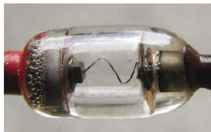
Rysunek 13. Stara germanowa dioda ostrzowa. Zwróć uwagę na płytkę germanu i sprężynowy drut ostrzowy
