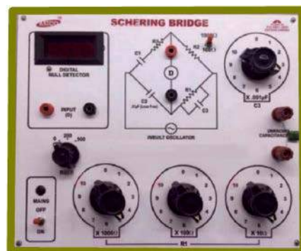
Laboratoryjna wersja mostka Scheringa (© IndiaMART)
