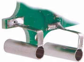
Dość niezgrabna konstrukcja złączy pomiarowych (© lygte-info.dk, pod redakcją Josa Verstratena)
