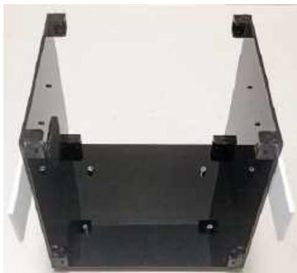
Fotografia 5. Montaż dolnej części obudowy
