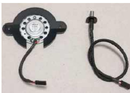
Fotografia 8. Uchwyty do przymocowania głośnika oraz czujnika temperatury
