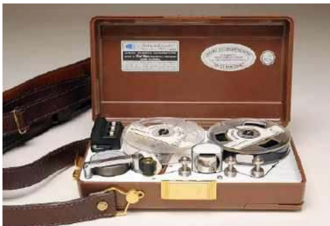
Fotografia 11. Rejestrator holterowski z taśmową pamięcią magnetyczną starego typu ( https://t.ly/w6RMB )
