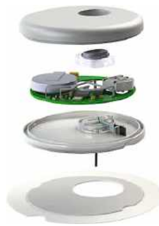
Fotografia 18. Budowa czujnika CGM marki Abbott ( https://t.ly/WOW66 )
