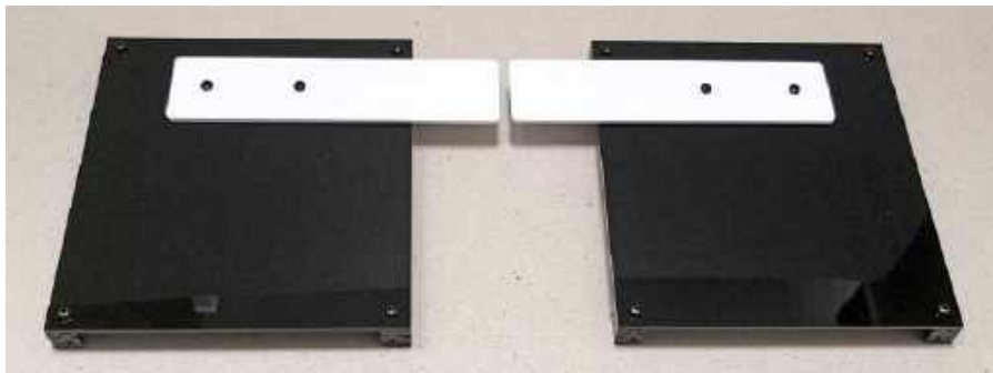
Fotografia 3. Przykręcenie „rąk” z białego szkła akrylowego
