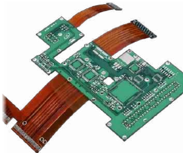
Fotografia 2. Rozbudowany obwód drukowany w technologii rigid-flex
