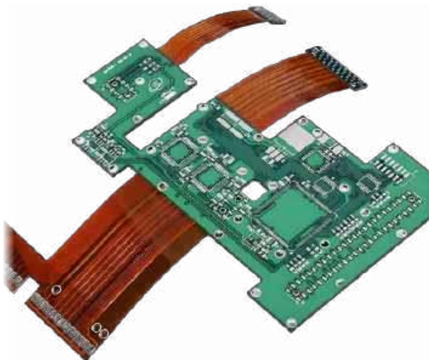
Fotografia 2. Rozbudowany obwód drukowany w technologii rigid-flex
