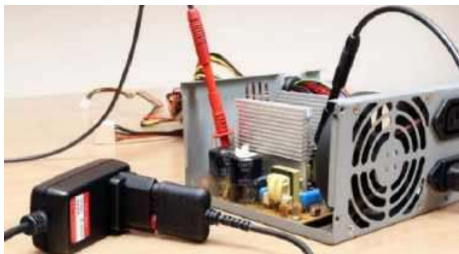
Fotografia 4. Zastosowanie analizatora Handyscope TP450 do pomiarów zasilacza ATX
