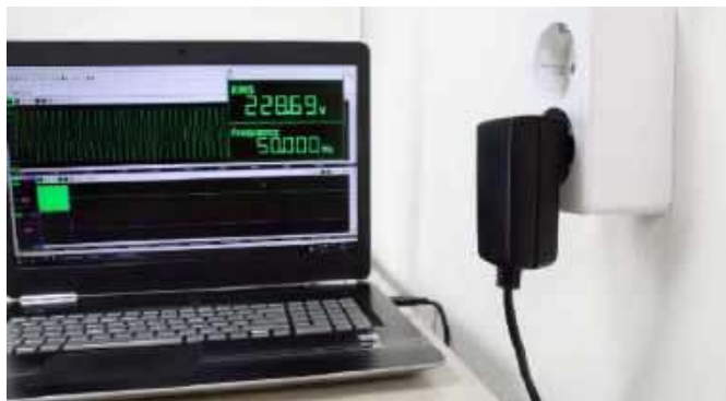
Fotografia 5. Zastosowanie analizatora Handyscope TP450 do pomiarów napięcia sieciowego
