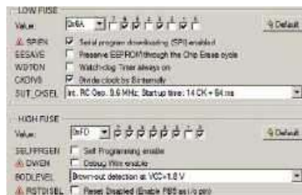
Rysunek 4. Szczegóły ustawienia bitów zabezpieczających
