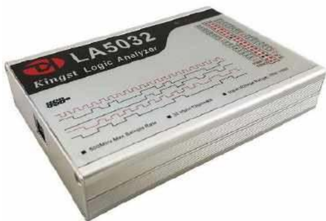
Fotografia 5. Analizator stanów logicznych LA5032 marki KingstVis [2]
