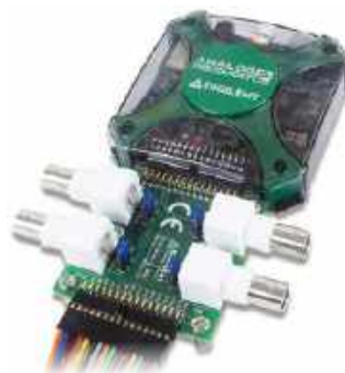
Fotografia 4. Urządzenie wielofunkcyjne Analog Discovery 2 marki Digilent [2]
