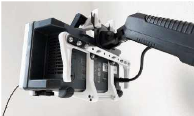
Fotografia 5. Uchwyt pozwalający na zamontowanie oscyloskopu do uchwyty VESA (źródło: thingiverse.com)
