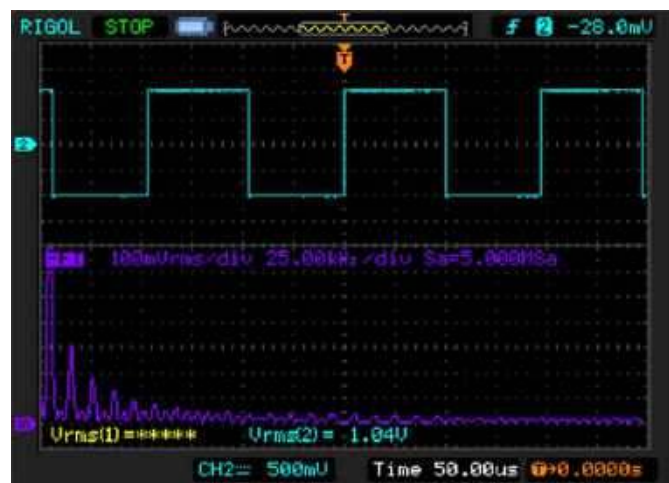
Rysunek 54. Analiza FFT sygnału prostokątnego
