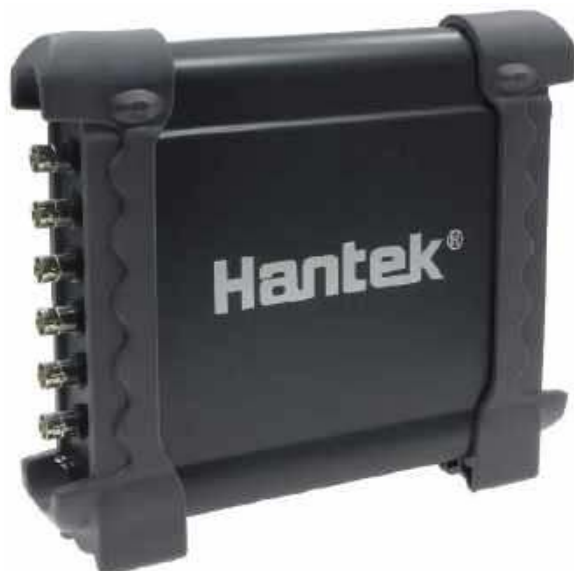
Fotografia 6. Ośmiokanałowy oscyloskop w formie przystawki USB marki Hantek [1]
