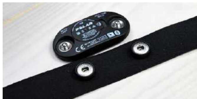
Fotografia 8. Przykładowy pulsometr z pasem piersiowym marki Polar. Widoczne zatrzaski pełniące rolę mechanicznego mocowania urządzenia oraz podłączenia do elektrod EKG ( https://t.ly/PSLfr )
