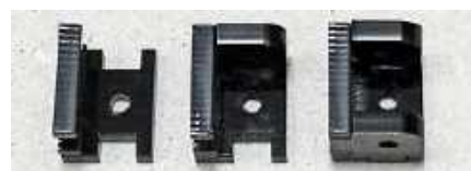
Fotografia 1. Kolejność klejenia elementów połączeniowych
