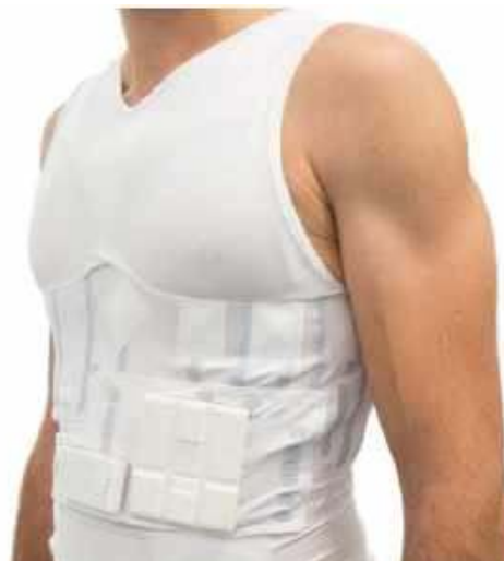
Fotografia 14. Koszulka z wbudowanymi elektrodami EKG ( https://t.ly/lx7dJ )
