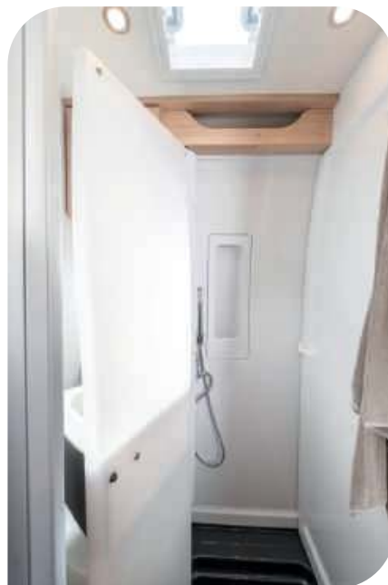
Schwenkbad to łazienka obrotowa, tj. z kurtynami rolowanymi ścian
