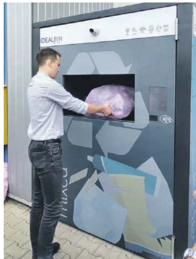
Po włożeniu do wnętrza worka z śmieciami kosz waży ilość i sprawdza jakość wyrzucanych odpadów
