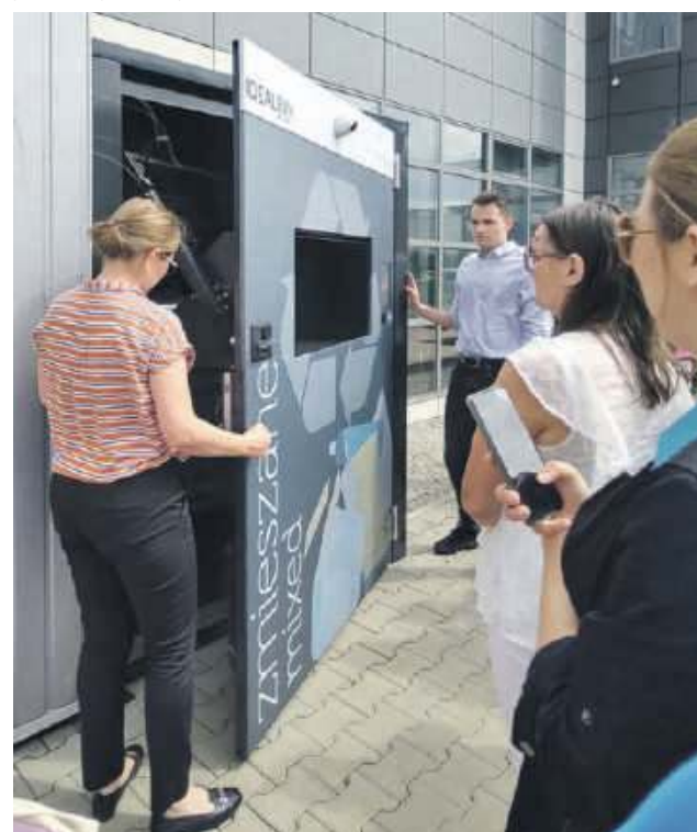
Przednia ściana kosza się otwiera tak, by firma wywożąca odpady bez problemu mogła wyjąć i opróżnić znajdujący się w środku pojemnik
