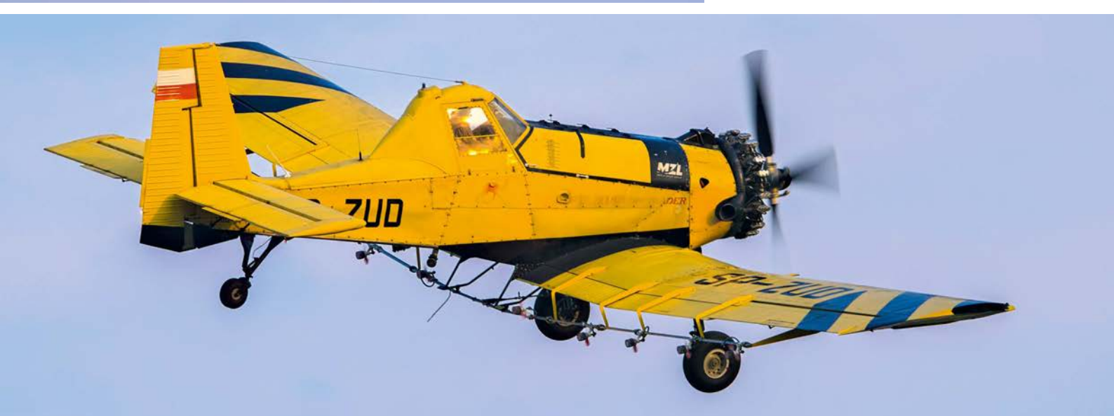
M18B Dromader (SP-ZUD) z zamontowaną pod płatem instalacją służącą do prowadzenia oprysków upraw rolniczych. Fot. Marcin Strembski
