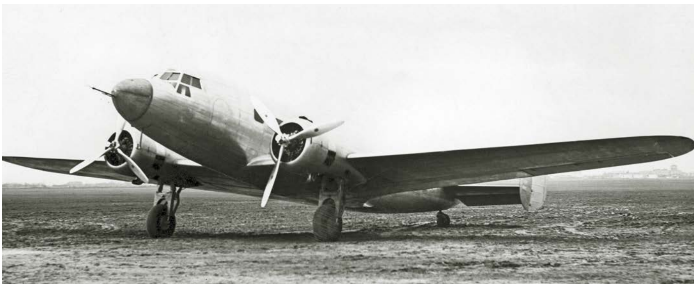
PZL-44 Wicher na Okęcie. Ze względu na długi rozbieg i dobieg ta prototypowa konstrukcja nie była predestynowana do operowania z lotnisk polowych czy improwizowanych lądowisk. Wicher został przekazany LOT-owi 29 grudnia 1938 roku. Symptomatyczne, miesięczne opóźnienie w rozpoczęciu prób eksploatacyjnych wskazuje na rezerwę niektórych decydentów w odniesieniu do perspektywy – chociażby wyłącznie testowego – użytkowania przez LOT nowego samolotu komunikacyjnego krajowej proveniencji. W próbach Wichra w locie, realizowanych w PLL LOT od 30 stycznia 1939 roku, aktywnie uczestniczył pilot W. Klisz (wraz z pilotami K. Bocheńskim, F.K. Długaszewskim, T.T. Karpińskim, J.G. Mitzem i M.S. Płonczyńskim). Właśnie wcześniej zdobyte doświadczenie stało się powodem powierzenia W. Kliszowi dowodzenia Wichrem w godzinach popołudniowych 1 września. W czasie wrześniowych operacji samolot nosił oznaczenia polskiego Lotnictwa Wojskowego (szachownice). Fot. NAC
