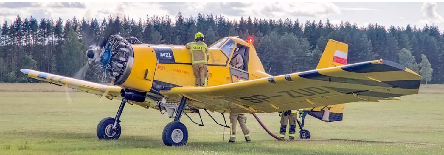
M18B Dromader (SP-ZUD) podczas tankowania wody do zbiornika za pomocą węży strażackich zasilanych z wozu bojowego Straży Pożarnej.
