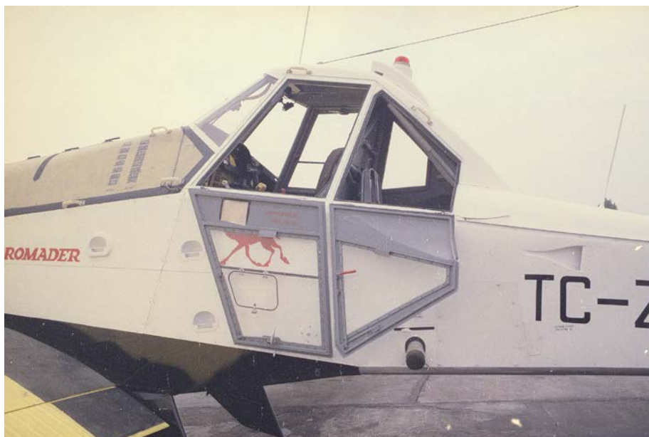
W wersji M18A wykonano kabinę dla mechanika za kokpitem, przy czym fotel zamontowano plecami do kierunku lotu. Niewielkie drzwi wejściowe z oknem znajdowały się po lewej stronie kadłuba.
