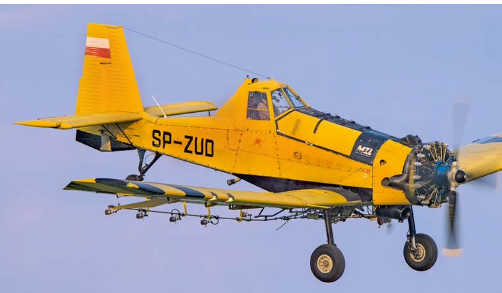
M18B Dromader (SP-ZUD) z zamontowaną pod płatem instalacją służącą do prowadzenia oprysków upraw rolniczych. Fot. Marcin Strembski
