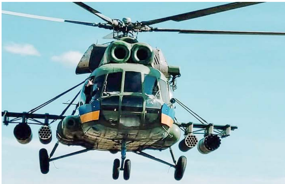
Ukraiński śmigłowiec Mi-8 z bardzo ciekawym, mieszanym zestawem podwiesz, na które składają się amerykańskie wyrzutnie M261 niekierowanych pocisków rakietowych Hydra-70 kal. 70 mm (na pylonach wewnętrznych) i radzieckie B8W20 npr S-8 kal. 80 mm (na pylonach zewnętrznych).
