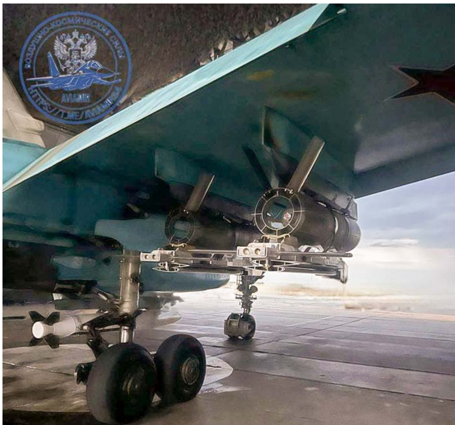
Rosyjski samolot uderzeniowy Su-34, który został jednocześnie uzbrojony w bomby szybujące OFAB-250-270 z modulem UMPK (pod skrzydłami) i bomby UMPB D-30SN (pod kadłubem).
