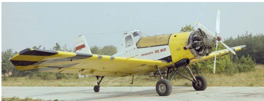
M21 Dromader Mini był napędzany silnikiem PZL-3SR z reduktorem o mocy 600 KM z czteropłatowym śmigłem samoprzestawialnym US 133 000 o średnicy 3100 mm. Maksymalny ładunek płatny wynosił 900 kg.
