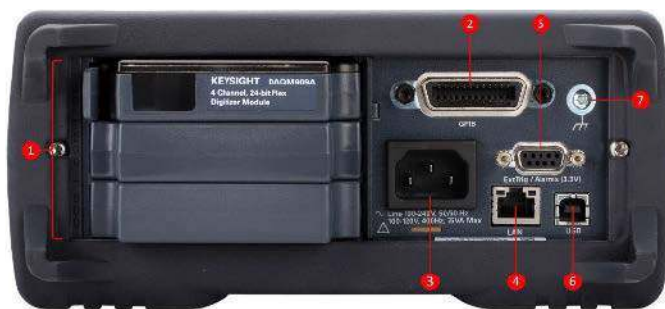
Fotografia 3. Widok panelu tylnego jednostki DAQ973A marki Keysight. 1 – sloty rozszerzeń, 2 – złącze interfejsu GPIB, 3 – gniazdo zasilania AC, 4 – gniazdo interfejsu Ethernet, 5 – port sygnałów dodatkowych (alarmy, wyzwalanie), 6 – gniazdo USB, 7 – zacisk uziemienia ( https://t.ly/0rPJh )
