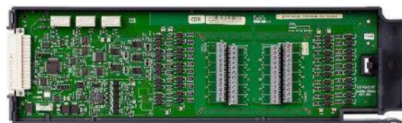
Fotografia 4. Widok modułu DAQM900A marki Keysight ( https://t.ly/2Nti1 )
