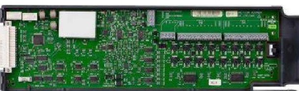
Fotografia 9. Widok modułu DAQM907A marki Keysight ( https://t.ly/2Nti1 )
