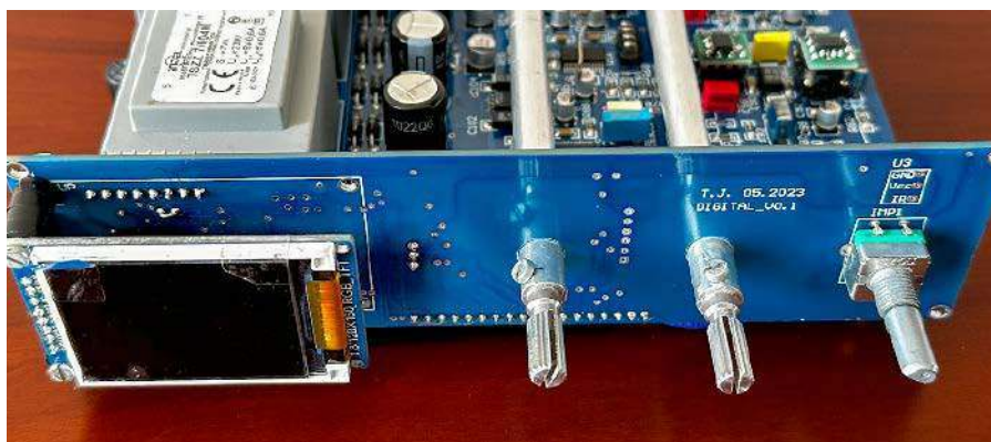
Fotografia 3. Płyta czołowa z wyświetlaczem i elementami manipulacyjnymi
