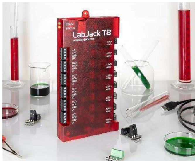
Fotografia 19. Moduł akwizycji danych LabJack T8 ( https://t.ly/8NrNh )
