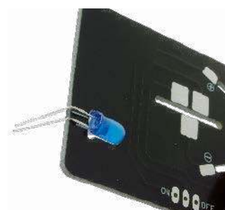
Fotografia 1. Sposób profilowania wyprowadzeń diod LED
