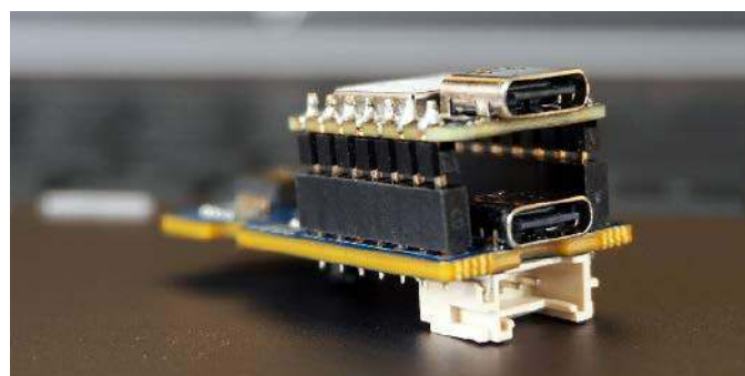
Fotografia 2. Moduł z ESP32 wraz z sensorem gestów
