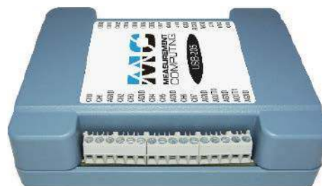
Fotografia 22. Moduł z serii USB-200 marki Measurement Computing ( https://t.ly/0gyuy )
