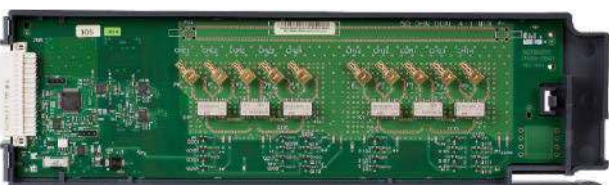
Fotografia 8. Widok modułu DAQM905A marki Keysight ( https://t.ly/2Nti1 )
