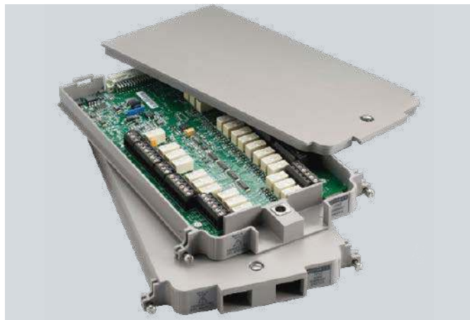
Fotografia 30. Moduł rozszerzeń 7753 marki Keithley ( https://t.ly/-M52V )
