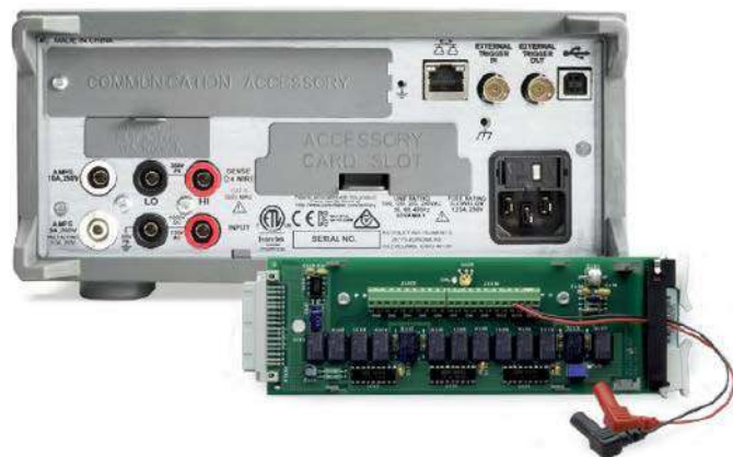
Fotografia 13. Panel tylny multimetru DMM6500 oraz moduł 9-kanalowego multipleksera termoparowego 2001-TCSCAN ( https://t.ly/Y3KF5 )
