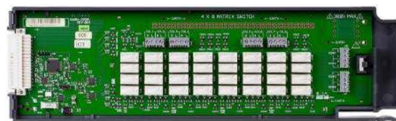
Fotografia 6. Widok modułu DAQM904A marki Keysight ( https://t.ly/2Nti1 )
