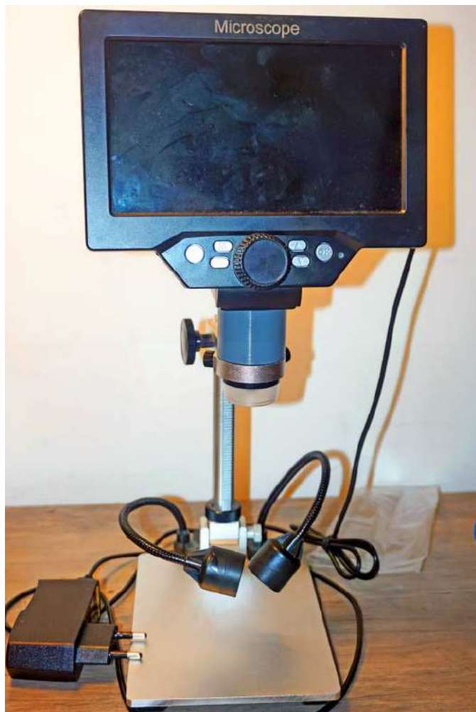
Fotografia 1. Kompletny mikroskop z dołożoną tuleją dystansową
