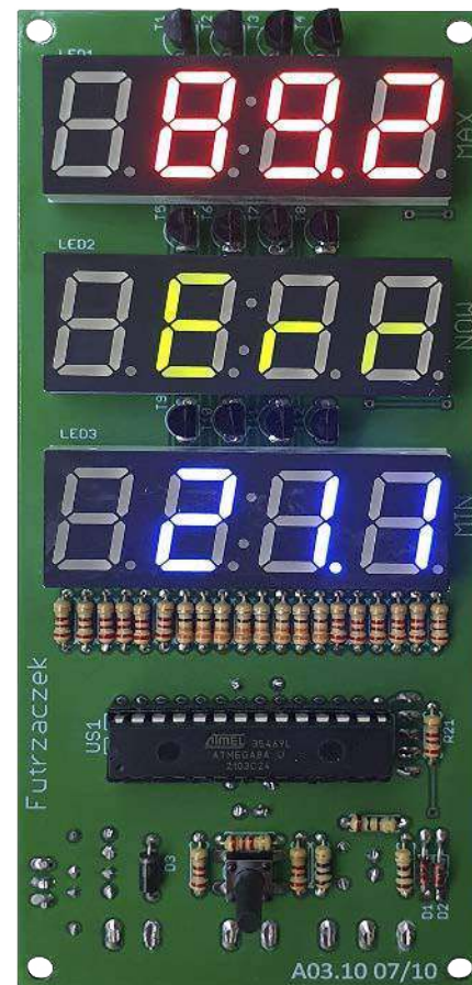
Fotografia 4. Wygląd wyświetlacza z komunikatem błędu czujnika
