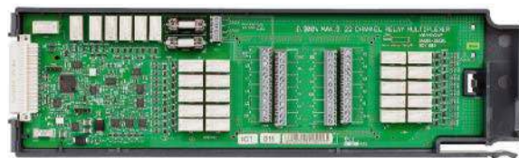
Fotografia 5. Widok modułu DAQM901A marki Keysight ( https://t.ly/2Nti1 )
