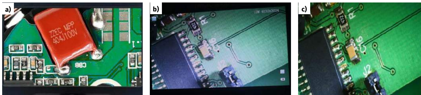
Fotografia 2. Jakość obrazu: a) z materiałów reklamowych; b) rzeczywista; c) zdjęcie zrobione przez testowane urządzenie
