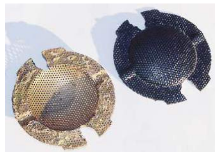
Rysunek 30. Maskownica membrany T27
