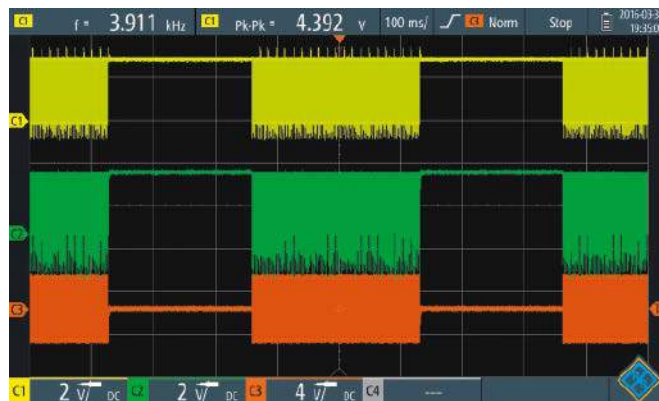
Rysunek 3. Ten oscylogram pokazuje te same sygnały komplementarne, ale przy znacznie mniejszej szybkości przemieszczania (100 ms / div). Sygnały mają długość ok. 280 ms i są oddzielone przerwami o długości ok. 220 ms. Czerwony przebieg pokazuje całkowity sygnał przyłożony do przetwornika i wynosi międzyszczytowo 6 V
