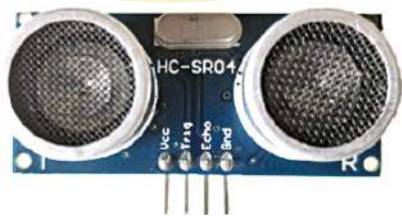
Rysunek 2. Szczegóły styków czujnika HC-SR04
