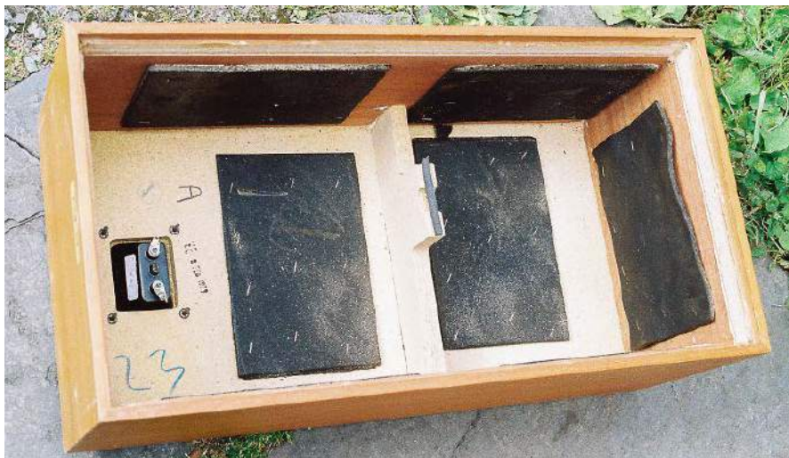
Rysunek 19. Tłumienie paneli głośników za pomocą podkładek tłumiących karoserię samochodową zmniejsza wibracje. Na zdjęciu prezentowane jest wnętrze obudowy KEF 104ab. (W moich demonstracjach w sali wykładowej, skradzionych z wykładów Lauri Fincham, znajdują się dwa kawałki sklejk – jeden z tłumieniem, drugi bez. Po uderzeniu patką jeden z nich wibruje, drugi wydaje tępy stukot)
