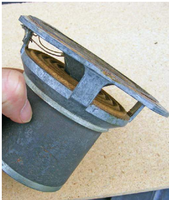
Rysunek 25. Pierwszy prawdziwy głośnik nisko-średniotonowy mini monitor zastosowany w modelu Goodmans Maxim z 1965 roku. Posiadał on zawieszenie membrany wykonane z tkaniny impregnowanej lateksem, w celu uzyskania odpowiedniej elastyczności. W późniejszej produkcji zmieniono je na zawieszenie gumowe. Sam kiedyś wykonałem podobne dla głośnika nisko-tonowego z płótna i kleju lateksowego Copydex
