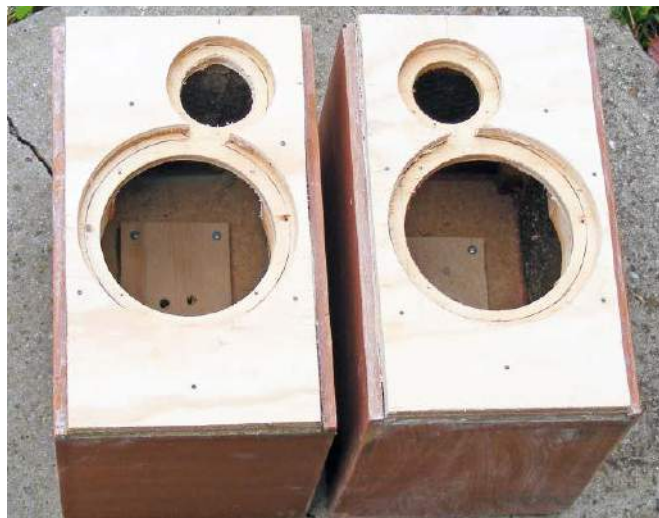
Rysunek 16. Montaż głośników niejako „chowający je” w płaszczyźnie obudowy pomaga zminimalizować efekty filtrowania grzebieniowego w paśmie górnych częstotliwości, spowodowane narastającym efektem dyfrakcji. Obudowy dla przetworników Wavecor mają fronty wykonane z dwóch sklejących ze sobą kawałków sklejk
