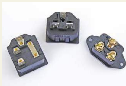
Rysunek 3.27. Trzy rodzaje męskich gniazd typu IEC – widok od tyłu. Należy unikać wersji z połączeniami śrubowymi (po prawej), gdyż trudno takie połączenia odpowiednio zaizolować
