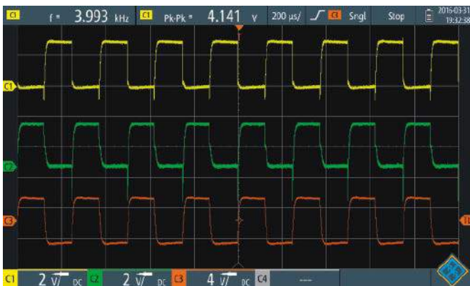
Rysunek 2. Żółte i zielone przebiegi pokazują komplementarne sygnały sterujące przyłożone do przetwornika piezoelektrycznego. Oba sygnały mają częstotliwość 3,99 kHz i amplitudę międzyszczytową zbliżoną do 3 V, bez uwzględnienia skoków przesterowania. Całkowity sygnał przyłożony do przetwornika jest pokazany na czerwonym przebiegu i wynosi międzyszczytowo 6 V
