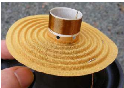
Rysunek 28. Zespół membrany B110A. Należy zwrócić uwagę na otwory w cewce z Nomexu, aby zapobiec wzrostowi ciśnienia pod osłoną przeciwpływową (co jest częstą przyczyną zniekształceń)
