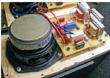
Rysunek 21. Tylna część przegrody LS3/5A z widoczną zwrotnicą. Została ona zamontowana ponad magnesem głośnika wysokotonowego przy użyciu filcowej podkładki o grubości 3/8 cala, aby zapobiec grzechotaniu. Obawiałem się, że magnes będzie wpływał na cewki ale nie udało mi się zmierzyć żadnej istotnej różnicy
