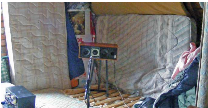
Rysunek 5. Aby zminimalizować odbicia dźwięku w pomieszczeniu podczas wykonywania pomiarów charakterystyki częstotliwościowej, konieczne jest wyłożenie ścian materiałem pochłaniającym dźwięk. Przedstawione tutaj materace na moim strychu pomagają zapewnić niemal bezchłowe warunki dla wartości powyżej kilkuset herców. Na zdjęciu widać testowany system aktywny Meridian M2
