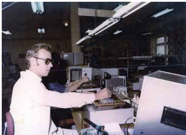
Stanowiska strojenia płytek do radiomagnetofonów RB-3200
