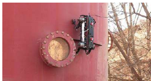
1. Robot MARVEL wspina się po ścianie zbiornika
