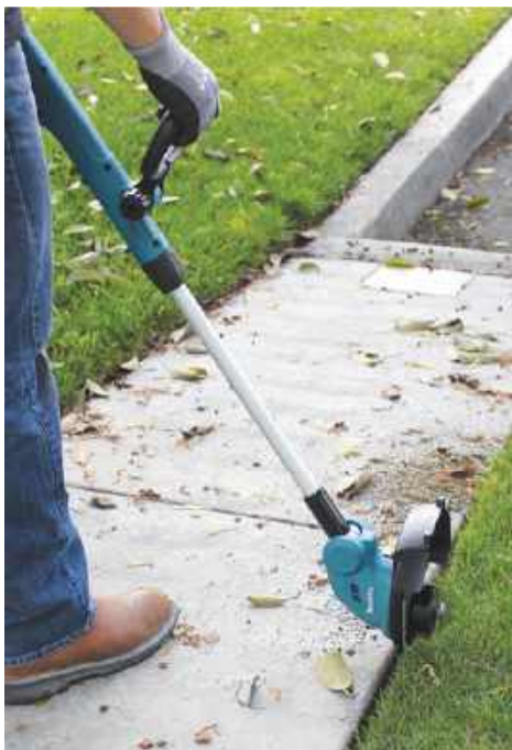
🔌 W podkaszarce elementem tnącym jest zwykle nylonowa żyłka. MAKITA
