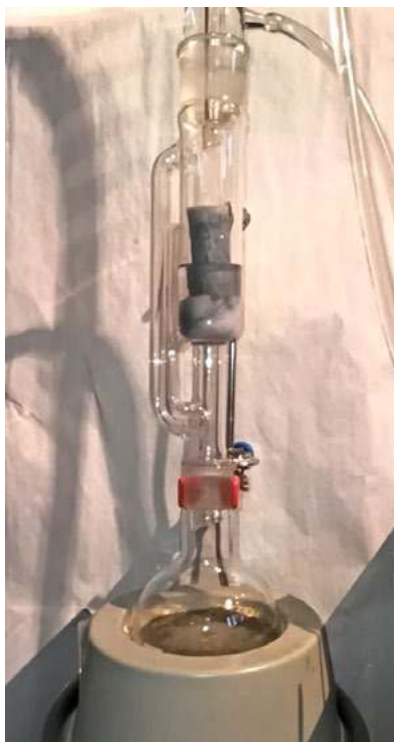
Fot. 7 – Aparat Soxhleta zestawiony w celu rekrystalizacji akrydonu
