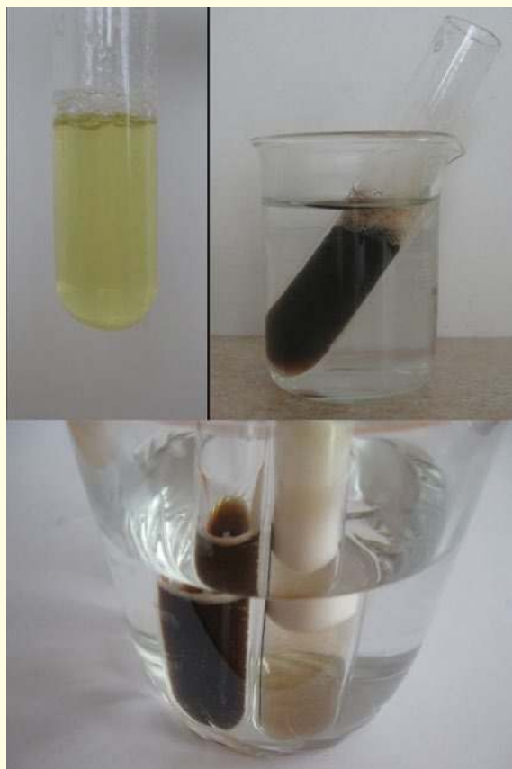
Fot. 5. Doświadczenie 7. U góry: z lewej roztwór białka jaja kurzego w wodzie, z prawej – ciemny osad siarczku ołowiu(II). U dołu: utlenianie siarczku ołowiu do siarczanu (próbówka po lewej – siarczek, próbówka po prawej – siarczan).
