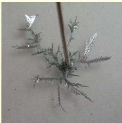
Fot. 7. Doświadczenie 9. Fraktalna struktura drzewka Saturna otrzymanego elektrolitycznie.
