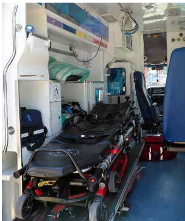
Fot. 2. Wnętrze przedziału medycznego ambulansu transportowego. Widoczne jest podstawowe wyposażenie, tj. nosze główne, defibrylator z łyżkami, dozownik tlenu oraz kołnierze ortopedyczne.
