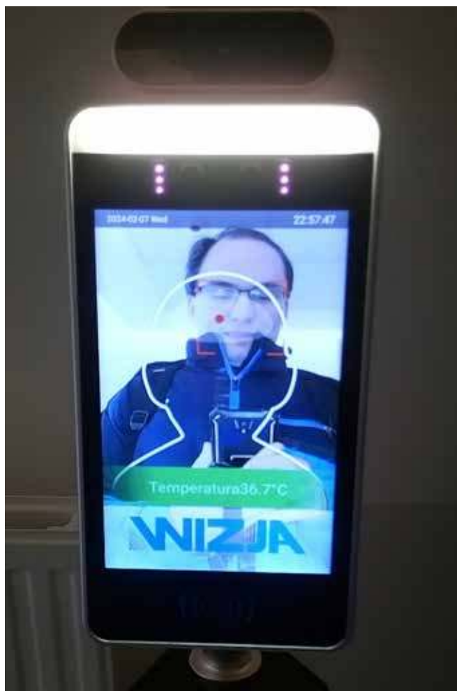
Fot. 6. Wyposażone w kamerę termowizyjną urządzenia do bezdotykowego pomiaru temperatury umieszczane są np. w placówkach ochrony zdrowia.
