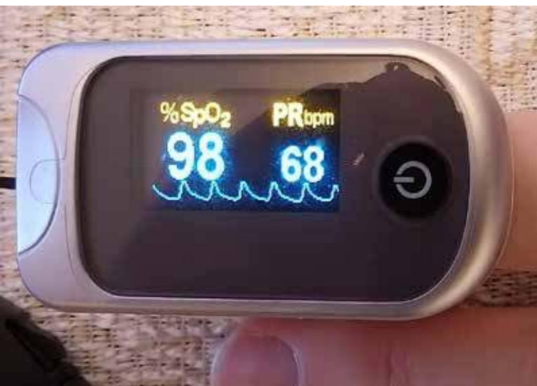
Fot. 1. Na wyświetlaczu pulsoksymetru pokazane są wartości pulsu (PR bpm), wysycenia krwi tlenem (% SpO2) oraz krzywa pletyzmograficzna.
