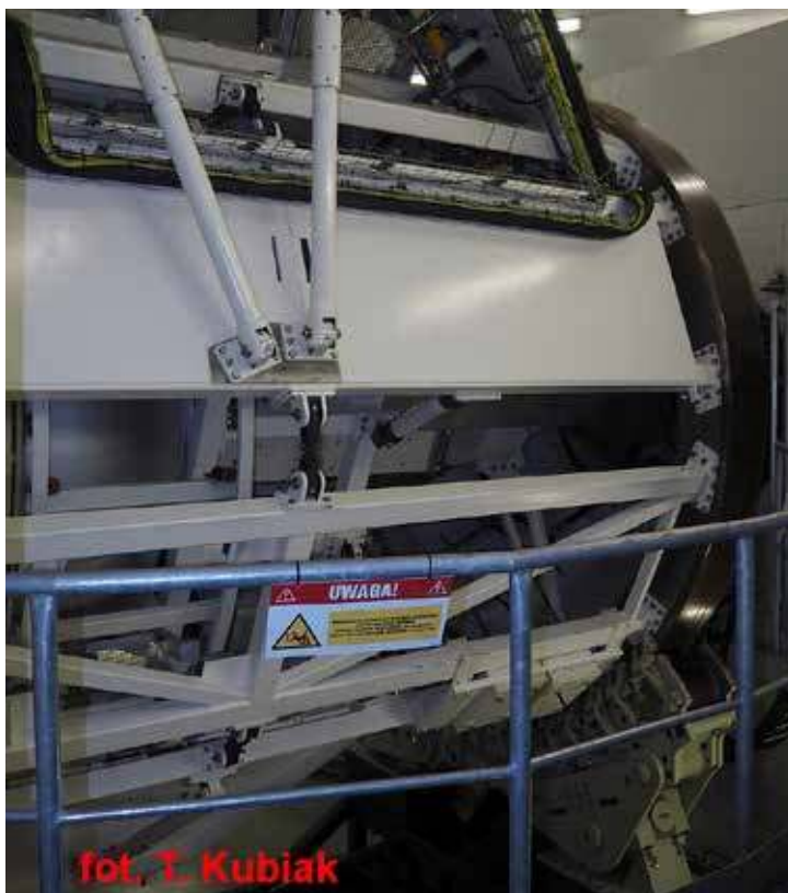
Fot. 2. Gantry, czyli stalowa obrotowa konstrukcja z magnesami odchylającymi wiązkę terapeutyczną, umożliwia napromienianie zmiany nowotworowej z różnych kierunków. Takie urządzenie o masie \approx 100 ton i średnicy 11 m przeznaczone do terapii protonowej znajduje się w Centrum Cyklotronowym Bronowice.
