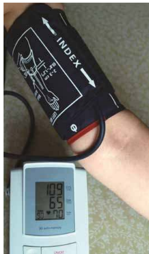
Fot. 3. Automatyczny ciśnieniomierz elektroniczny przeprowadzający pomiar metodą oscylometryczną.
