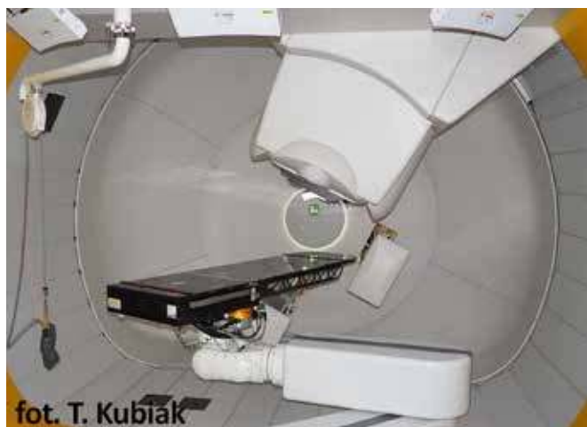
Fot. 6. Stanowisko gantry do terapii protonowej nowotworów w Centrum Cyklotronowym Bronowice w Krakowie.
