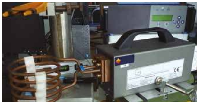
Fot. 2. Urządzenie do indukcyjnego nagrzewania roztworów nanocząstek stosowane w badaniach nad hipertermią magnetyczną.
