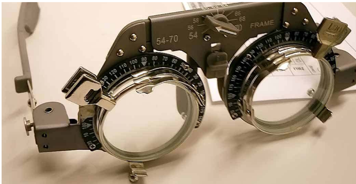
Fot. 1. Oprawy próbne ułatwiają właściwy dobór soczewek korygujących wadę wzroku.
