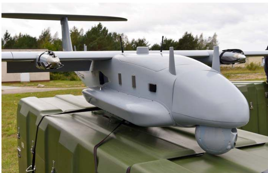
W skład systemu Gladius wchodzi dwa typy BSP – rozpoznawczy FT-5 (na zdjęciu wersja z radarem SAR i głowicą optoelektroniczną) i uderzeniowy BSP-U.
