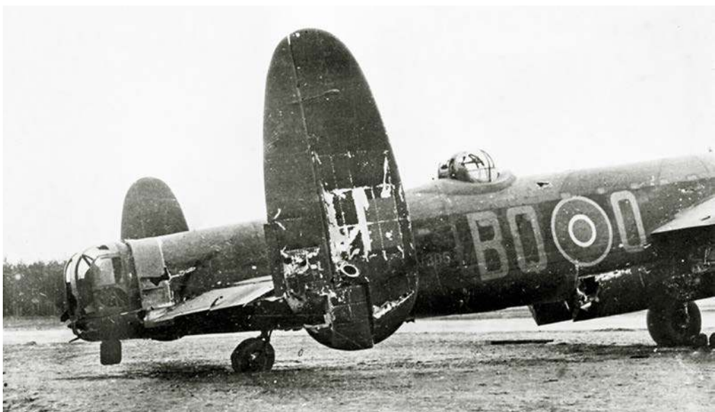
Przykład uszkodzeń, z jakimi wracały Lancastery do baz podczas powietrznej bitwy o Berlin. W nocy z 16 na 17 grudnia 1943 roku pięć maszyn wróciło z uszkodzeniami od ognia niemieckich myśliwców, a 17 od pocisków artylerii przeciwlotniczej.
