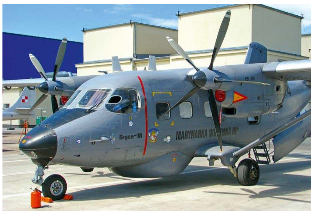
ZSRR przeniósł całkowicie do Polski produkcję silników TWD-10B, które pod oznaczeniem PZL-10S są użytkowane i wspierane do dzisiaj, stanowiąc napęd wywodzących się z An-28 samolotów Bryza.
