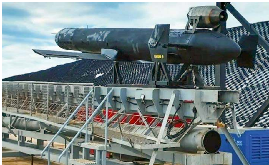
Niskokosztowy pocisk manewrujący Gerań-5 na wyrzutni startowej. Chociaż niektórzy usiłują dopatrzeć się podobieństwa do pocisku HESA Karrar , to rosyjski Gerań-5 jest wyraźnie odmienną konstrukcją, być może tylko koncepcyjnie inspirowaną irańskim odpowiednikiem.
