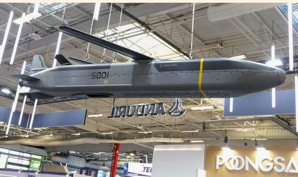
Pocisk SLB-500M Barracuda może być zrzucony z platform powietrznych (bojowych i transportowych), a po zamontowaniu silnika startowego również wystrzeliwany z wyrzutni naziemnych. Docelowo Barracuda ma mieć zasięg 500 mil morskich (nieco ponad 900 km), długotrwałość lotu do 120 minut i przenosić wewnątrz wymienne ładunki o masie do 45 kg. Oczekuje się, że koszt produkcji pojedynczego egzemplarza nie przekroczy 200 tys. USD.
