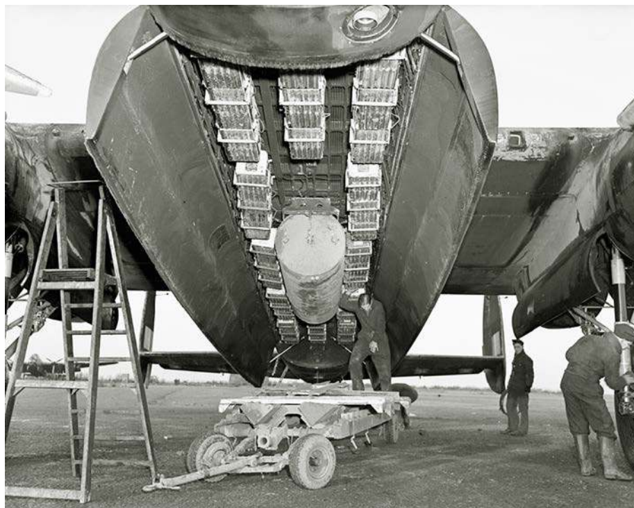
Typowy ładunek Lancastera w przypadku nalotów na Berlin – bomba burząca ( Cookie ) o masie 1816 kg (4000 funtów) i 12 zasobników z bombami zapalającymi.
