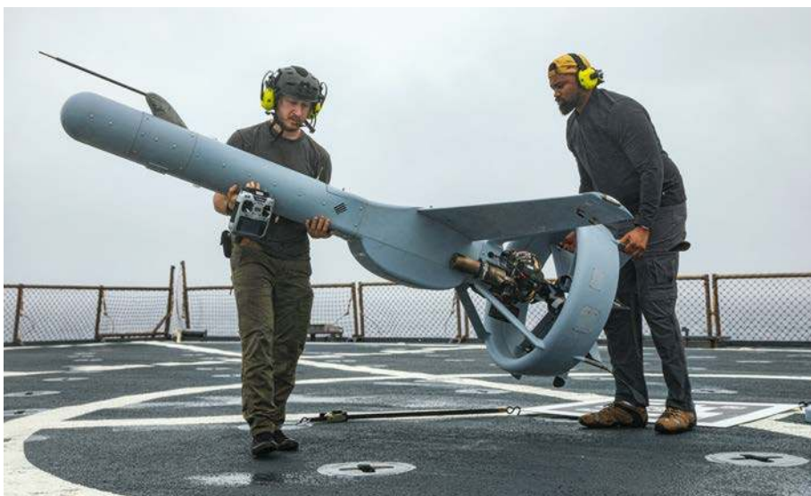
V-BAT jest pionowzłotem, który wymaga do startu i lądowania pola o wymiarach zaledwie 3,6 × 3,6 m.
