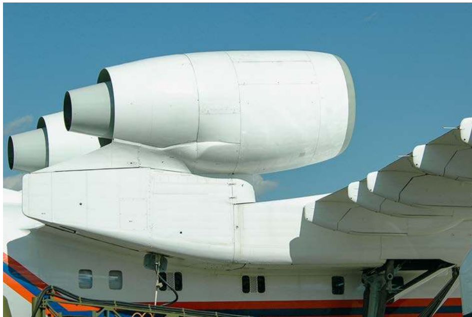
Silniki turbodrzutowe D-436TP zamontowano na pylonach nad skrzydłem, aby zapobiec dostawianiu się wody do wlotów powietrza podczas startu i lądowania.
