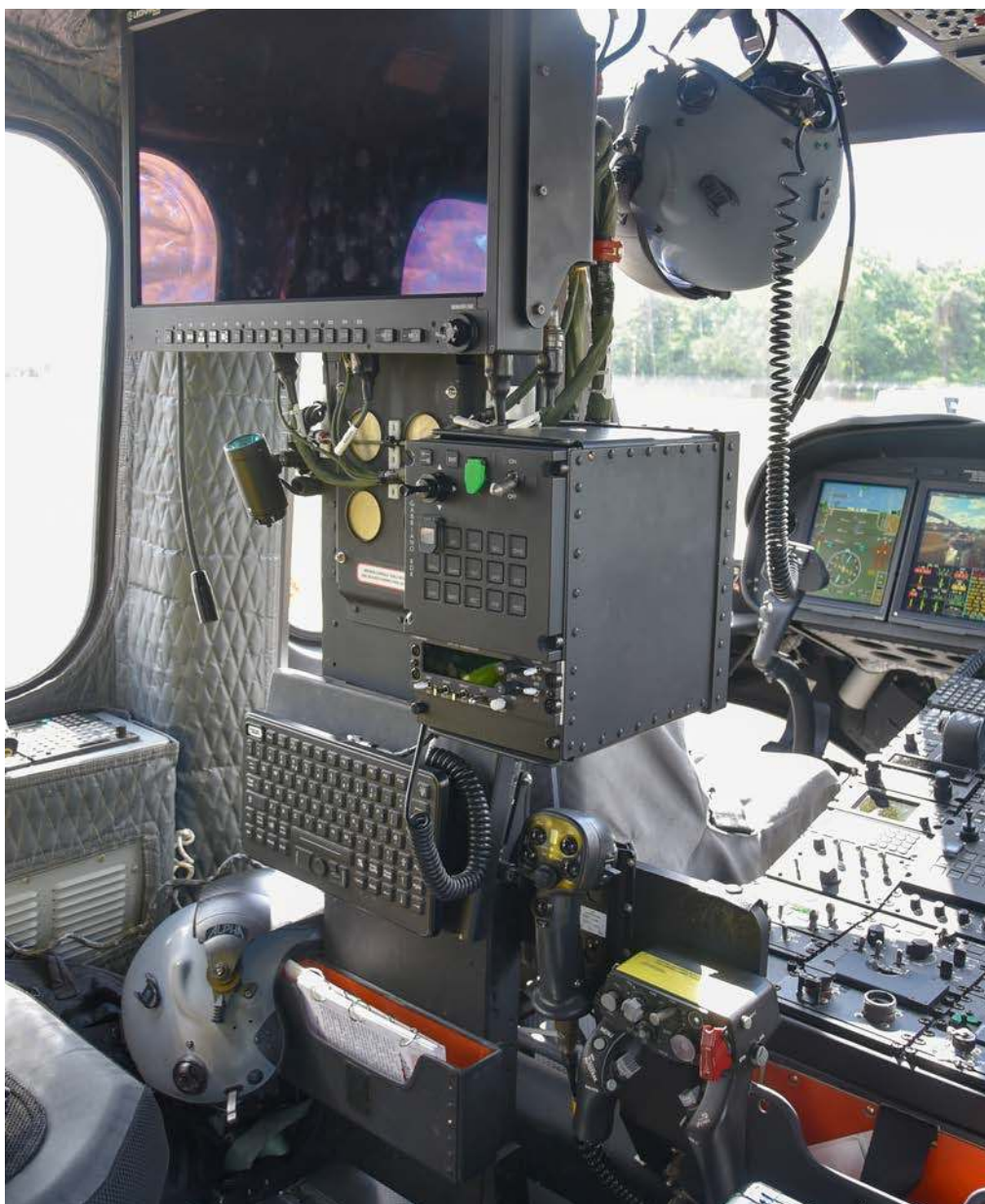
Konsola operatora głowicy optoelektronicznej.
