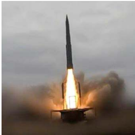
27 lutego ukraińska firma Fire Point opublikowała nagranie z testu odpalenia nowego krajowego pocisku balistycznego FP-7. Zasięg pocisku ma dochodzić do 200 km, prędkość maksymalna 1500 m/s, odchylenie kołowe trafienia 14 m, masa głowicy 150 kg.
