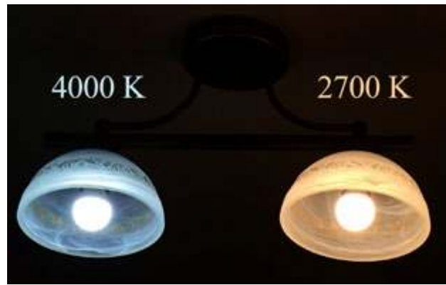
Fot. 1. Dwupunktowa lampa sufitowa z zainstalowanymi (w celu porównania) żarówkami LED 5 W, emitującymi światło o odmiennych temperaturach barwowych: 4000 K (barwa neutralna) i 2700K (barwa ciepła).
