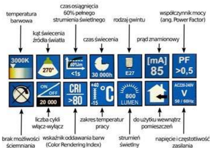
Rys. 1. Oznaczenia piktograficzne umieszczone na opakowaniach od źródeł światła LED.
