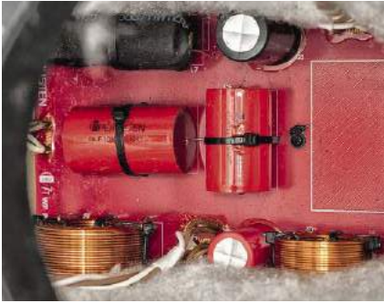
Sekcja filtrów dla 18-tek, a więc dwa filtry dolnoprzepustowe.
