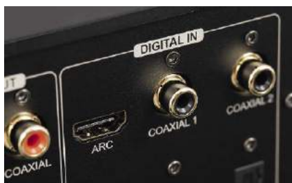
Wyjście HDMI uzupełniono o kanał zwrotny eARC.
