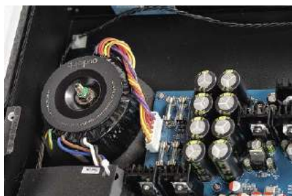
Zasilacz to rozbudowany układ liniowy z transformatorem toroidalnym.
