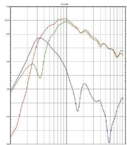
rys. 4. Charakterystyki w zakresie niskotonowym (poniżej 1 kHz, pomiar w polu bliskim).
