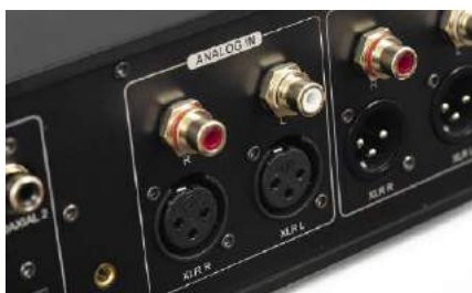
Unikalną cechą urządzenia jest wbudowany przedwzmacniacz analogowy, któremu towarzyszą wejścia XLR – cały tor sygnału jest symetryczny.
