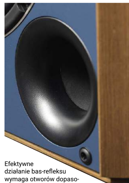
Po takim głośniku poznamy JBL-a na odległość. Membrana celulozowa z koncentrycznymi przetłoczeniami, piankowe zawieszenie... Brakuje tylko „wąsów” – doprowadzeń do cewki, które kiedyś specjalnie głośnik wyróżniały.
