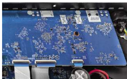
Górne piętro zajmują układy sieciowe i mini-komputer z systemem Rose OS.
