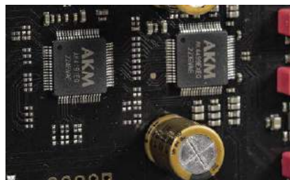
Zamiast wszechubogiego przetwornika ESS Technology, EverSolo wykorzystało po jeden z najnowszych układów firmy AKM.
