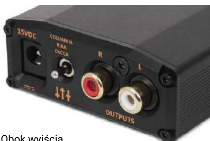
Obok wyjścia umieszczono przełącznik krzywych korekcyjnych.
