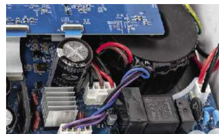
Na dolnym piętrze umieszczono układy audio i liniowy zasilacz (z transformatorem toroidalnym).
