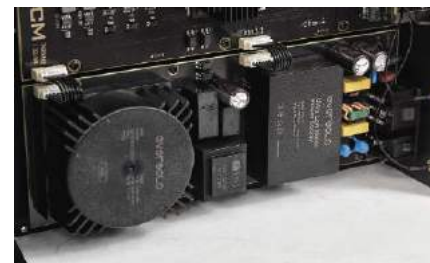
Zasilacz łączy układy liniowe (sekcja audio) oraz impulsowe (sterowanie).
