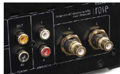
Wyjściu analogowemu RCA (z regulacją głośności) towarzyszy analogowe wejście i funkcja przedwzmacniacza.
