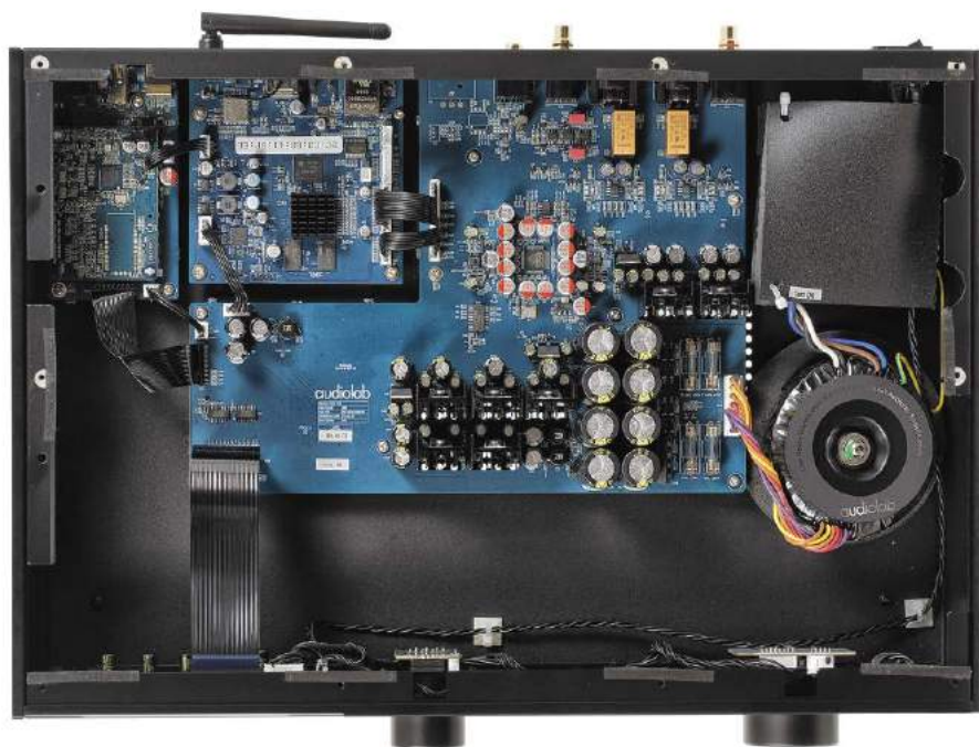
Obwody rozdzielono między cztery główne płytki drukowane.
