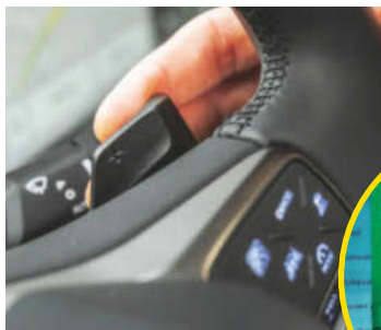
Łopatki służą głównie do regulacji rekuperacji. W trybie manualnym wymusza się nimi zmianę biegów.
