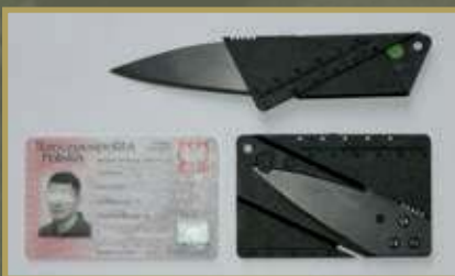
OSTRZE UKRYTE W OBUDOWIE, PRZYPOMINAJĄCEJ KARTĘ KREDYTOWĄ (PRZED ROZŁOŻENIEM). ROZMIARAMI POKRYWA SIĘ Z BLANKIETEM DOWODU OSOBISTEGO. W CELU UTRUDNIENIA ZIDENTYFIKOWANIA OSTRZA WYKONANO JE W JEDNOLITYM KOLORZE CO OBUDOWA. NA TYM SAMYM ZDJĘCIU POWYŻEJ, TEN SAM NÓŻ PO ROZŁOŻENIU; FOT.: ARCHIWUM AUTORA
