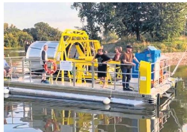
Pływająca platforma w formie katamaranu, na której zamontowana jest turbina
