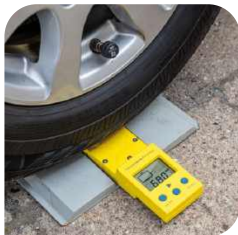
Fot. 3. Świadomość to podstawa. Samodzielne zważenie pojazdu jest dziś możliwe przy użyciu dostępnych w sklepach wag. To tylko kilka minut przed wyruszeniem w drogę
