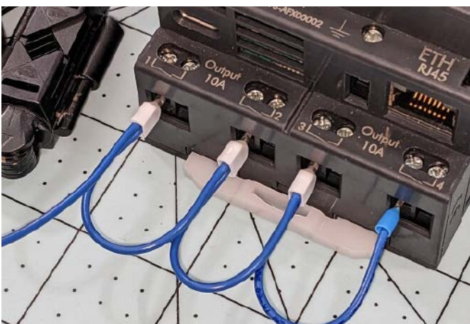
Fotografia 19. Zastosowanie końcówek podwójnych do wykonania połączeń w topologii daisy-chain ( http://t.ly/SfDpr )
