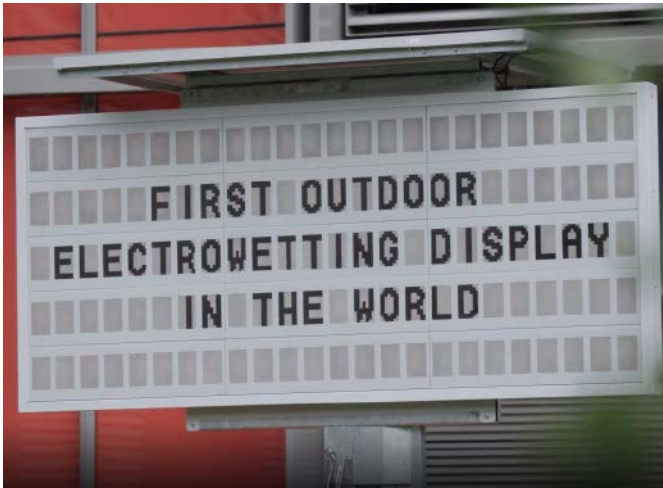
Fotografia 6. Wyświetlacz w technologii elektrozwilżania (EWD) – http://t.ly/uCUYm
