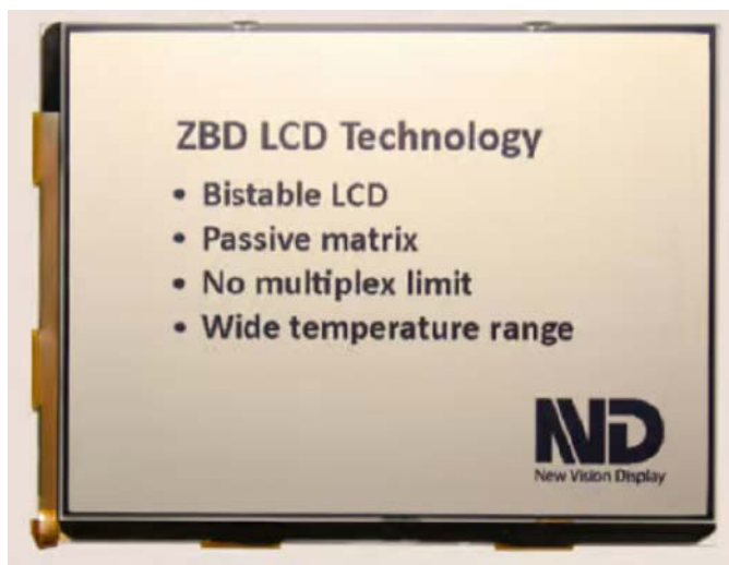
Fotografia 8. Działanie bistabilnego wyświetlacza LCD ( http://t.ly/nte2_ )
