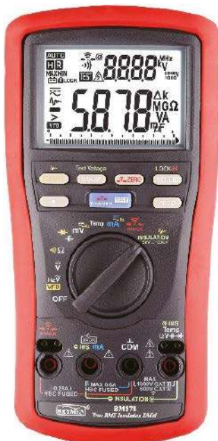
Fotografia 1. Miernik przenośny Brymen BM878 z funkcją pomiaru rezystancji izolacji przy napięciu testowym przestrajającym w zakresie 50...1000 V (http://t.ly/e_LHj)
