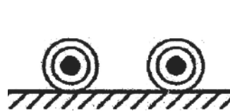
Rysunek 4. Przewody zamontowane na powierzchni w sposób nieprzylegający ( http://t.ly/im_yz )
