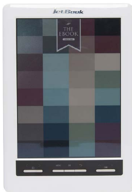
Fotografia 9. Jeden z pierwszych kolorowych wyświetlaczy E Ink Triton 2 ( http://t.ly/NvAZQ )
