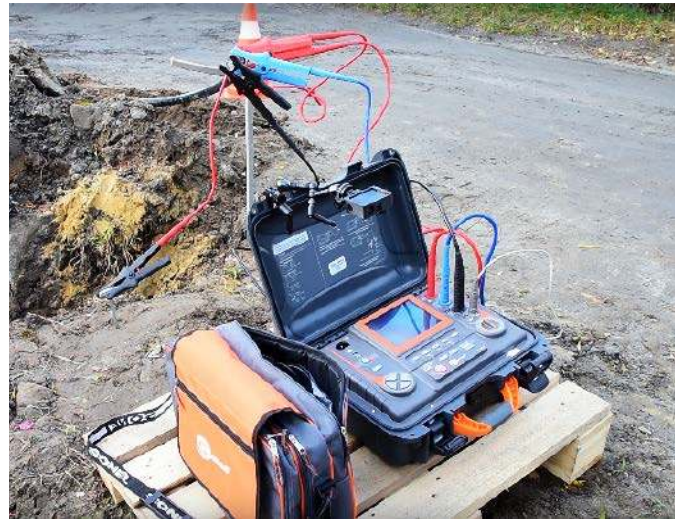
Fotografia 2. Pomiary rezystancji izolacji kabla ziemnego dokonywane za pomocą miernika Sonel MIC-10k1 (http://t.ly/1Mk_g)
