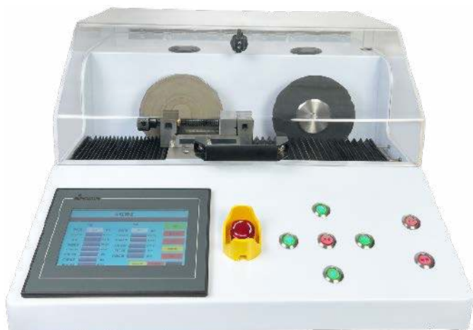
Fotografia 24. Automat marki Sinowon do przygotowywania i analizy przekrojów terminali zaciskanych ( http://t.ly/J5GAh )
