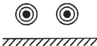
Rysunek 3. Przewody zamontowane na wolnym powietrzu ( http://t.ly/im_yz )
