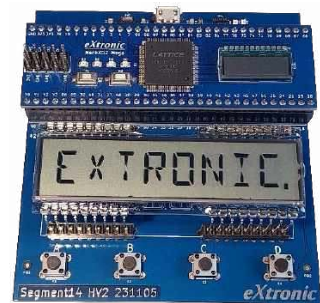
Fotografia 2. Uruchomiona płytką Segment14
