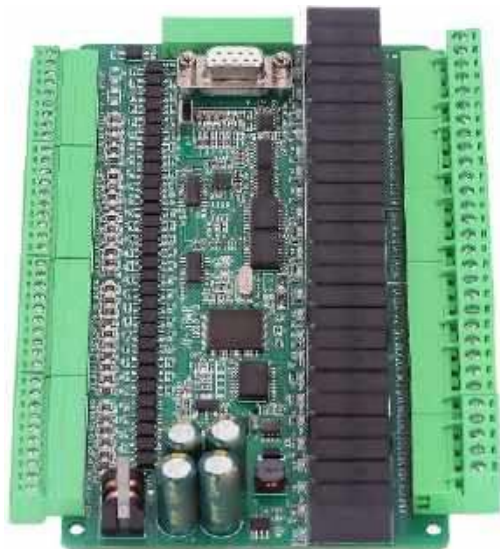
Fotografia 1. Przykładowa płytką drukowaną sterownika PLC z widocznym zestawem przełączników wyjściowych (po prawej). Źródło: http://t.ly/6PO3k
