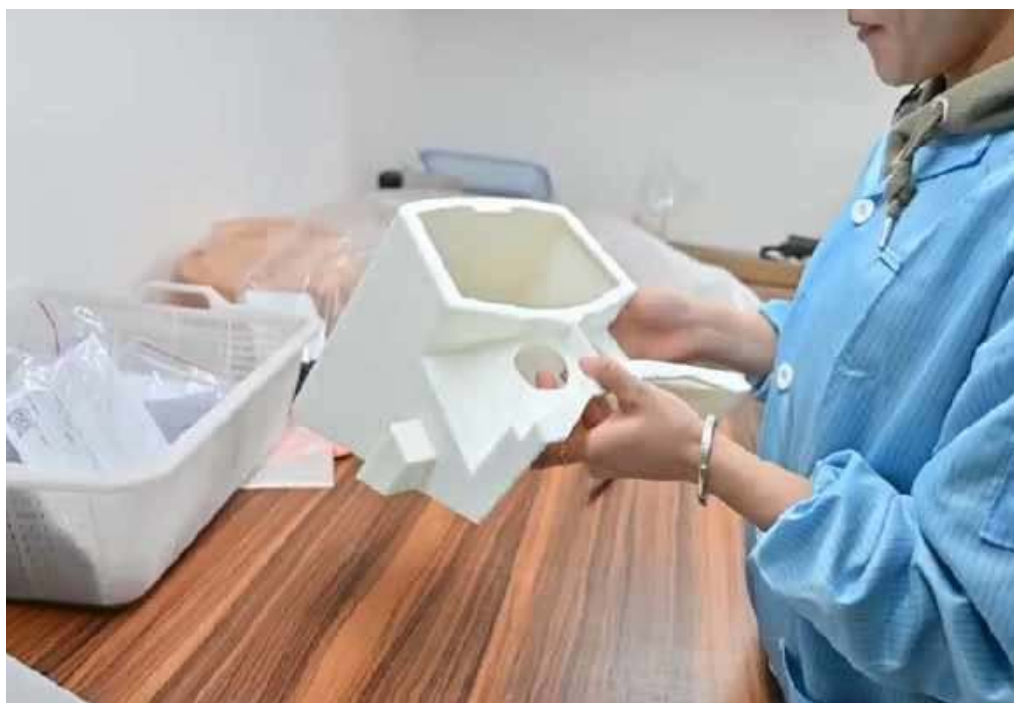
Fotografia 6. Stanowisko kontroli jakości detali wytwarzanych metodą druku 3D
