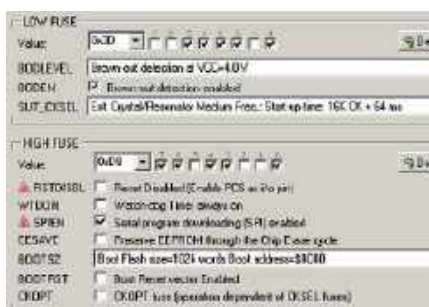
Rysunek 4. Szczegóły ustawienia bitów zabezpieczających
