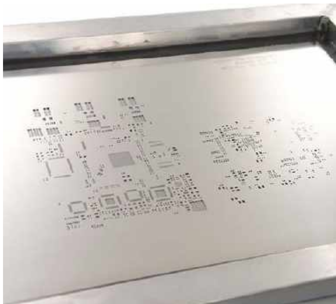
Fotografia 3. Przykładowy szablon do nakładania pasty lutowniczej
