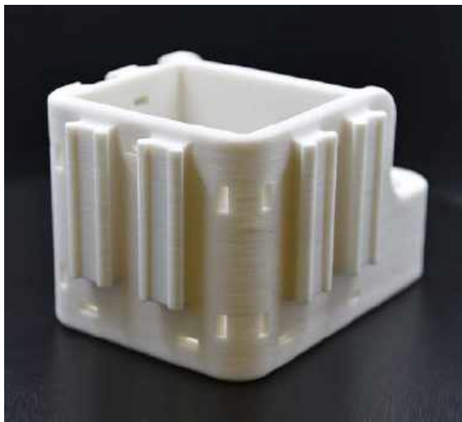
Fotografia 5. Przykładowy wydruk 3D z materiału PA12 (nylon)
